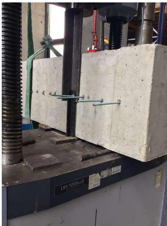
Ilustración 15. Montaje de ensayos a cortante
