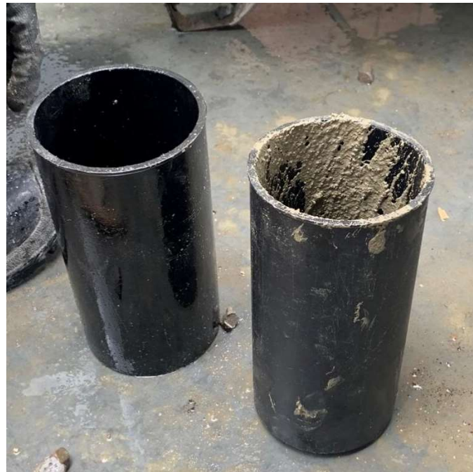
Ilustración 6. Cilindros de 10x20 cm para ensayos a compresión.
