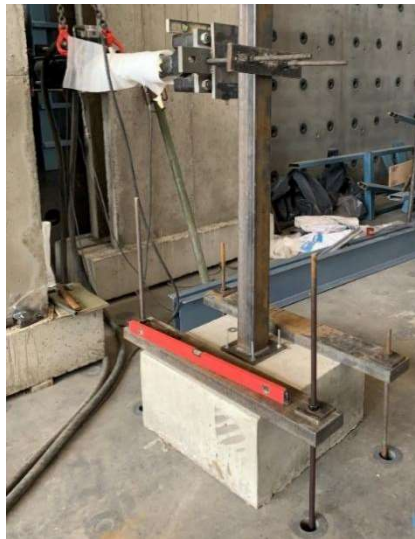
Ilustración 16. montaje en actuador para ensayo de carga cíclica.
