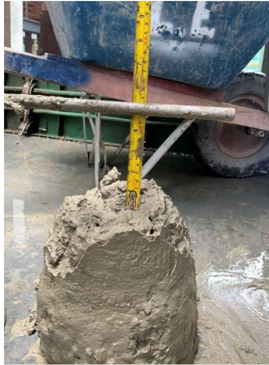
Ilustración 5. Resultado del ensayo de asentamiento: 5" o 12 cm
