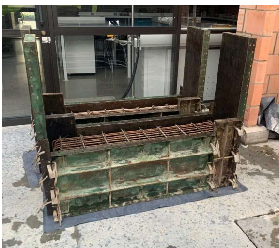
Ilustración 2. Refuerzo de vigas para ensayos a Corte de anclajes.
