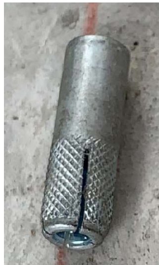
Ilustración 8. Chaso multiusos para anclajes mecánicos.
