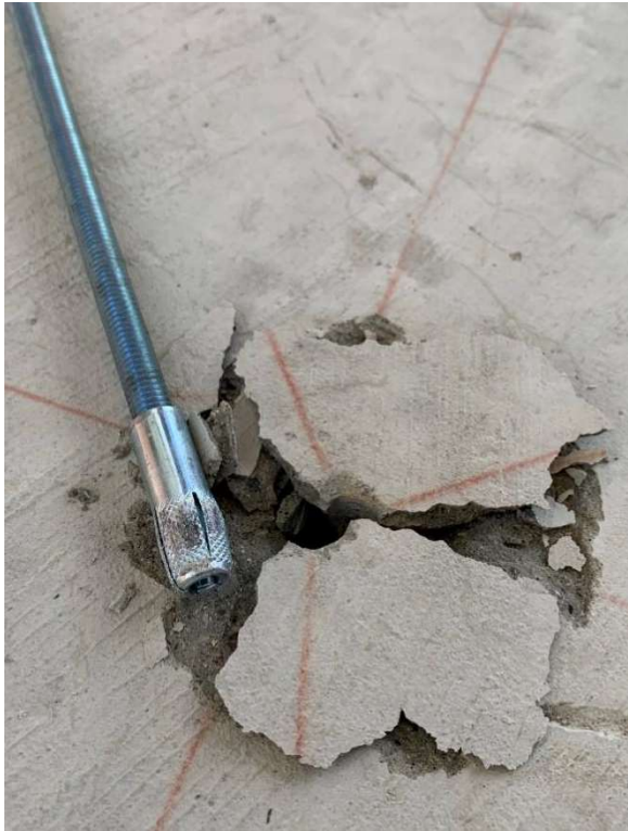
Ilustración 21. Falla por deslizamiento y arrancamiento del concreto
