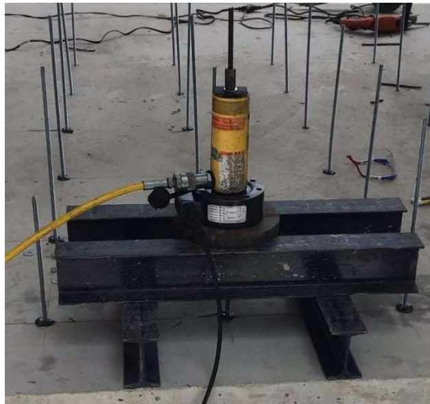
Ilustración 14. Montaje para ensayos a tensión no confinada.
