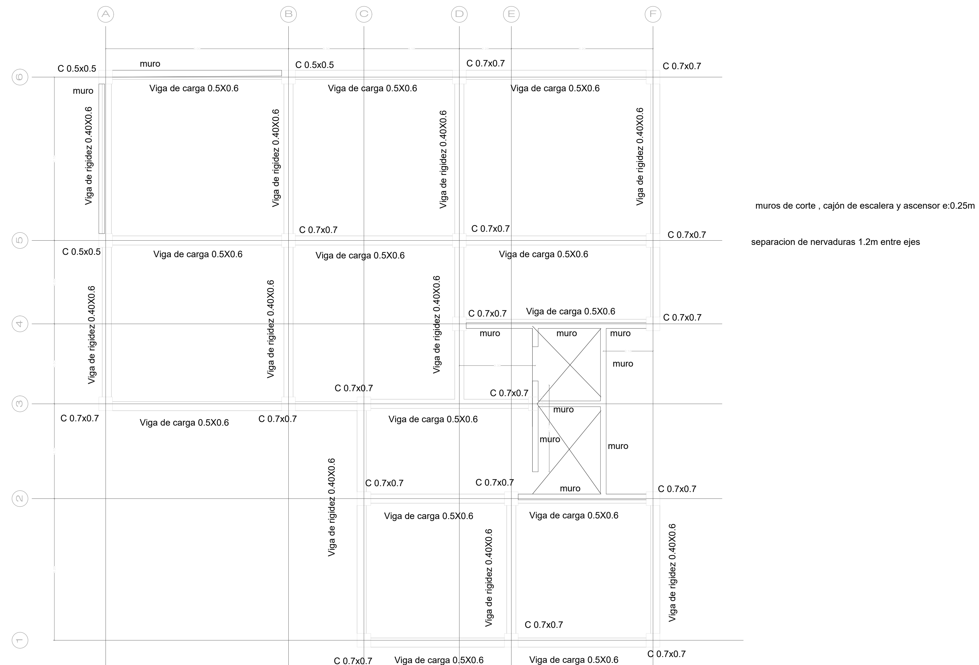
Planta estructural losa modelo 12 niveles tipo A
