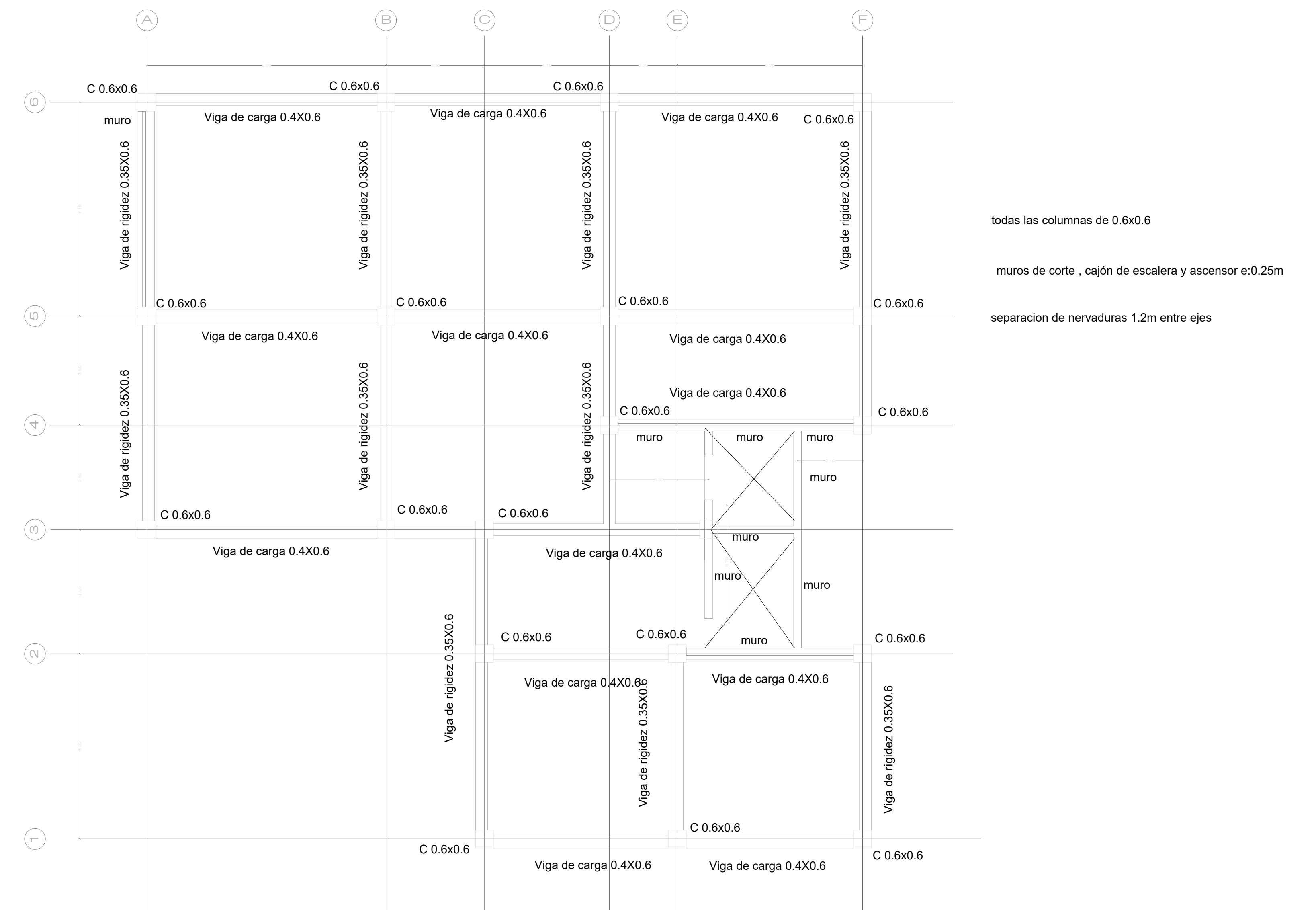
Planta estructural losa modelo 7 niveles tipo A
