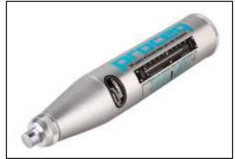
Ilustración 9 Modelo de martillo de Schmidt. (L. Vergara Reyes, 2017)
