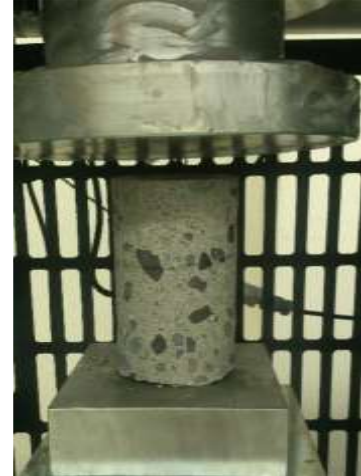
Ilustración 7 Ensayo a compresión de una probeta de hormigón (L. Vergara Reyes, 2017)
