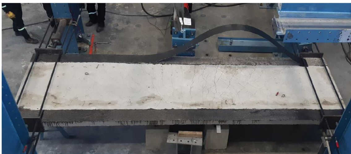
Figura 1.4 Despegue (Debonding) de láminas de FRP (Pulido, 2020)
