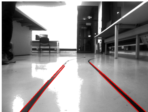
Figura 31: Líneas obtenidas con la transformada de Hough
