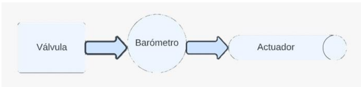
Figura 14. Esquema del montaje realizado para analizar el comportamiento del actuador ante la fuerza generada por una masa externa.
