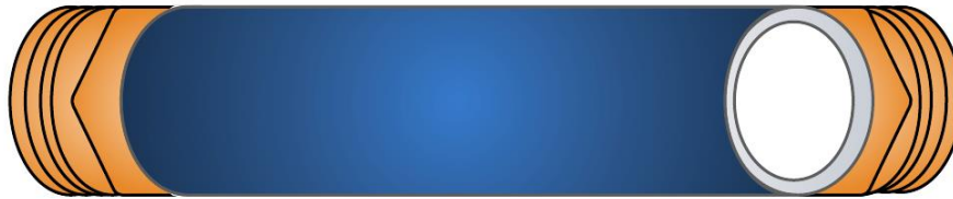
Figura 10. Actuador neumático posterior al proceso de grafado.
