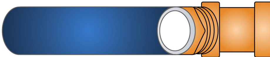
Figura 11. Actuador neumático grafado con unión para racor B103 de 1/8.
