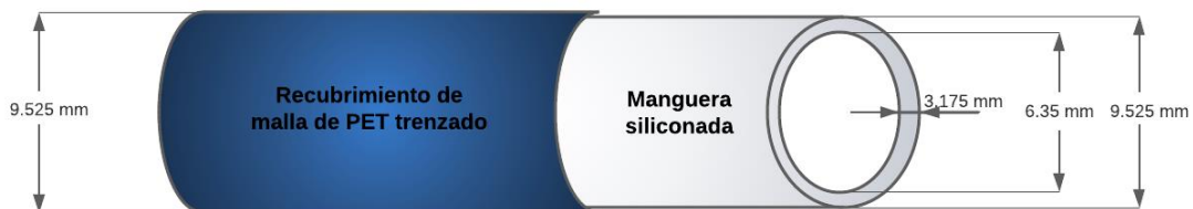
Figura 8. Disposición y dimensiones de las capas del actuador neumático.
