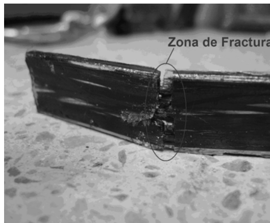
Figura 3b. Fotografía óptica donde se evidencia el daño por la grieta e la región donde se aplicó la carga.
