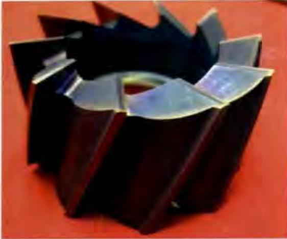
Figura 1. a) Fresa madre recubierta con TiAlN
