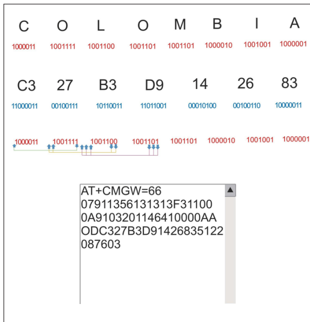
Figura 4. Codificación de un mensaje en modo PDU con codificación de 7 a 8.
