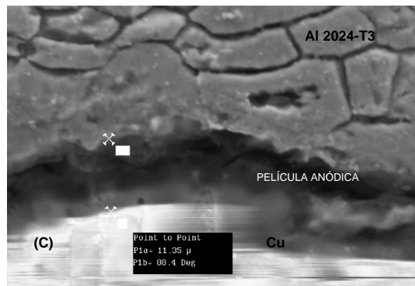
Figura 3. Micrografías a 5000X de las películas crecidas. (a) 10mA/cm 2 , (b) 15mA/cm 2 y (c) 20mA/cm 2 .
