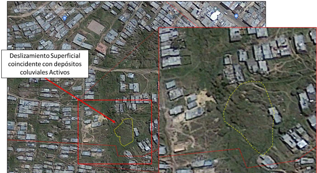
Figura 3.20. Deslizamiento superficial sobre suelo residual, imagen de Google Earth del 2013.
