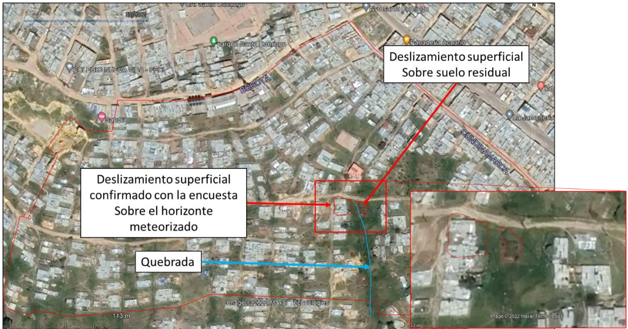
Figura 3.19. Deslizamiento superficial sobre suelo residual y el horizonte meteorizado, imagen de Google Earth del octubre 2012.
