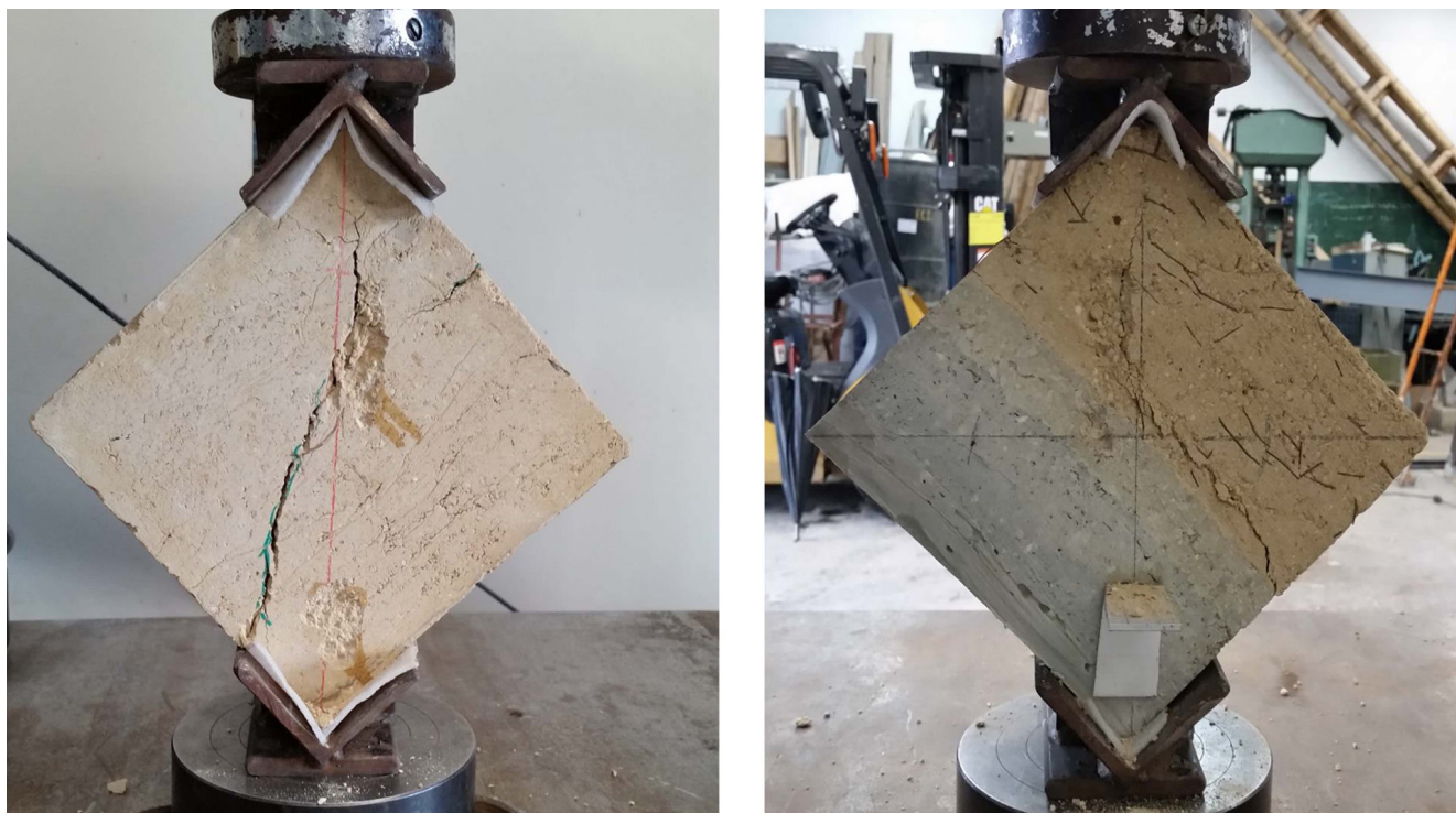
Figura 10. Ensayo de compresión diagonal, sin refuerzo y con la transición tierra-concreto propuesta.
