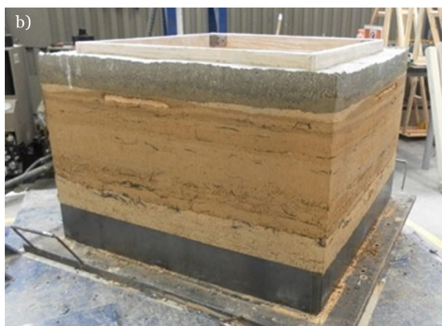
Figura 3. a) Composición de la transición entre el muro y la viga de concreto y b) Modelo de tapia pisada construido con la transición propuesta. Fuente: Autores.
