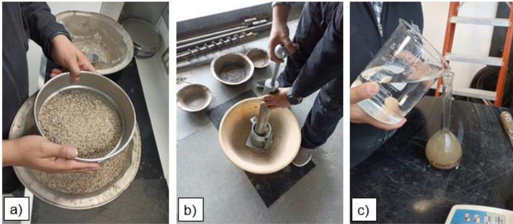
Figura 23 - Ensayos de caracterización del suelo; a) análisis granulométrico; b) ensayo normal de compactación; c) determinación de la gravedad específica del suelo.
