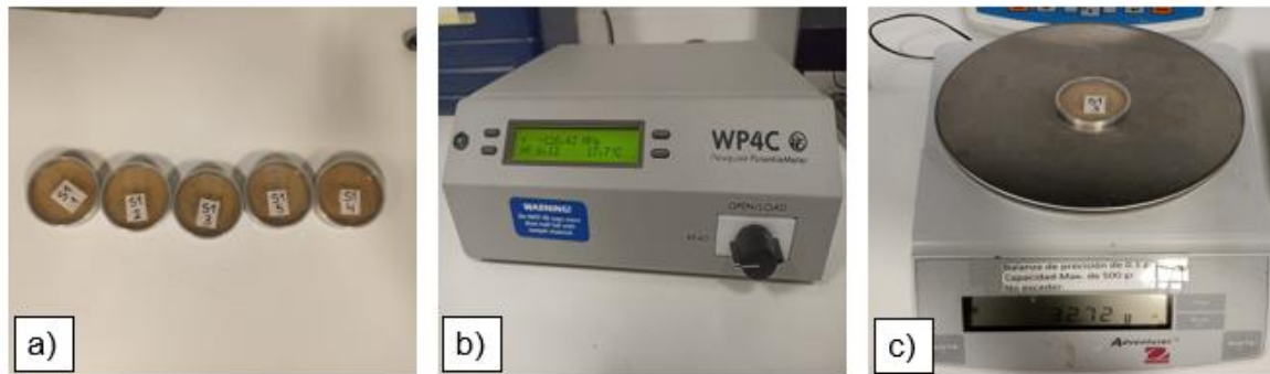
Figura 26 - Registro de humedad y succión; a) preparación de muestra de suelo; b) lectura de succión en WP4C; c) chequeo del contenido de humedad.
