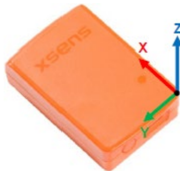
Figura 1. Coordenadas globales del sensor [9].
