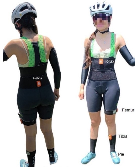
Fig. 14 Disposición de los sensores
