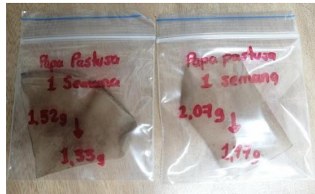
Figura 14 Muestra de la prueba de biodegradabilidad a la semana 1
