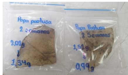
Figura 15 Muestra de la prueba de biodegradabilidad a la semana 2
