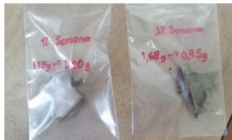
Figura 18 Muestra de la prueba de biodegradabilidad a la semana 12
