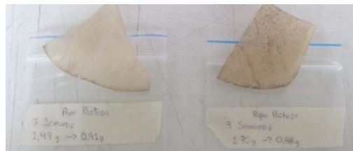
Figura 16 Muestra de la prueba de biodegradabilidad a la semana 3
