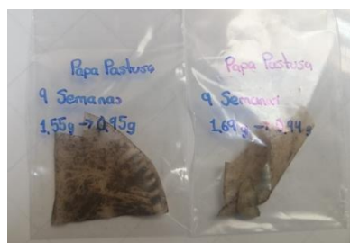
Figura 17 Muestra de la prueba de biodegradabilidad a la semana 9
