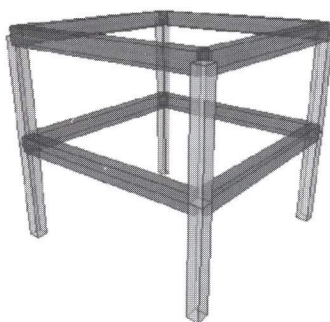
Figura 1. Modelo de pórtico de microconcreto de dos niveles.
