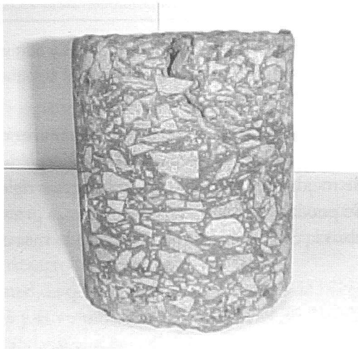
Fotografía 2. Fisuración de arriba hacia abajo (5).
