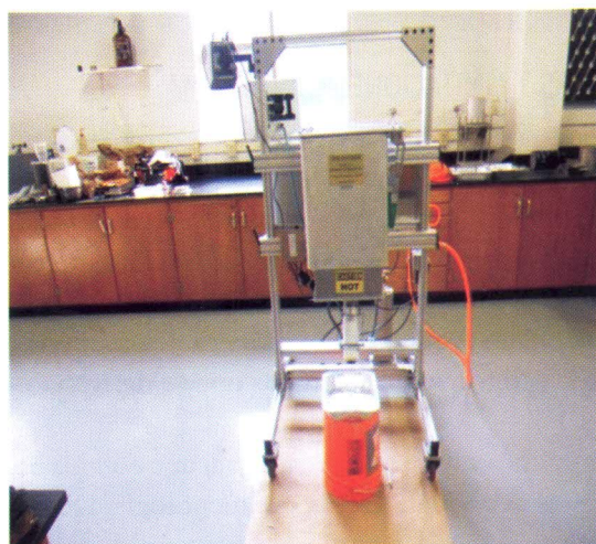
Figura 4. Esquema del Foamer , Pavement Technology Inc. (7).
