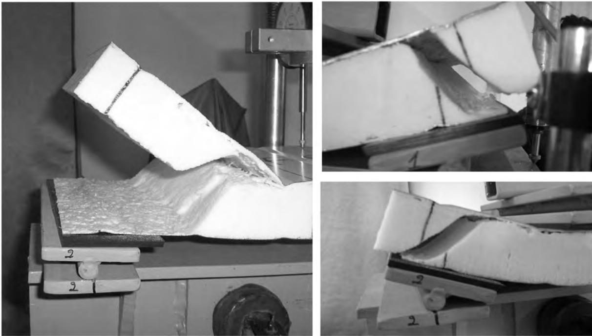
Figura 7 Fallas típicas de las probetas FB.
