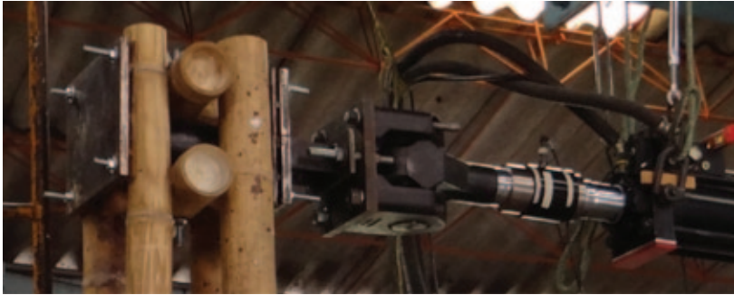
Figura 5. Dispositivo para la aplicación de carga
