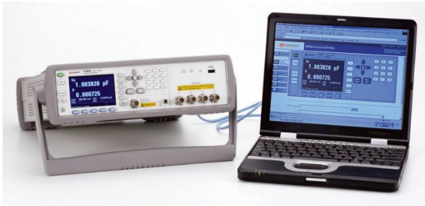
Figura 3.3: Equipo Keysight E4980AL-PCR conectado via USB a un ordenador con un software que permite registrar las mediciones [41].
