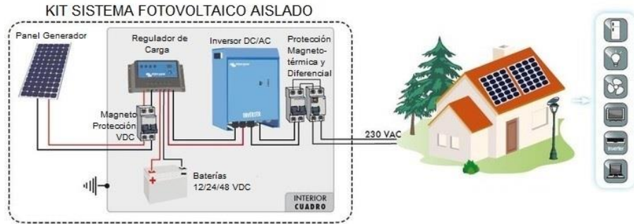
Ilustración 16 Sistema fotovoltaico aislado [30]
