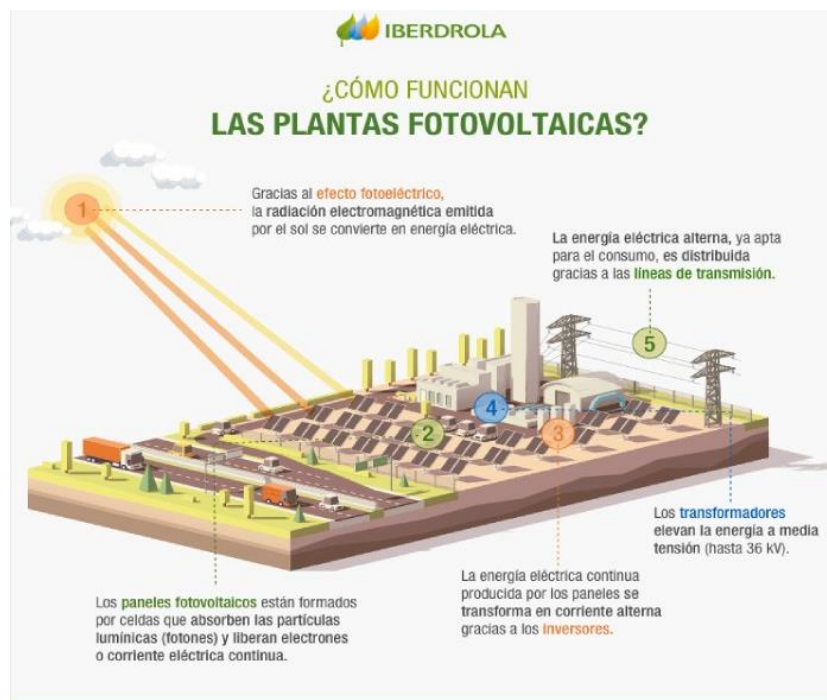
Ilustración 5 Funcionamiento planta fotovoltaica
