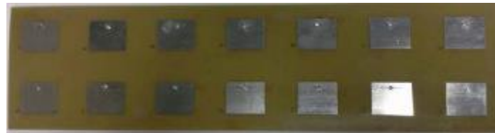
Figura 8. Arreglo de 14 elementos para ser ubicado en un dron. (Ibrahim, Deif y Sharawi, 2012).
