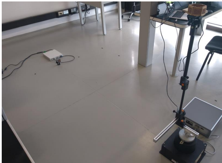
Figura 40. Configuración de las pruebas para la medición de RSSI de los arreglos en el laboratorio de telecomunicaciones.
