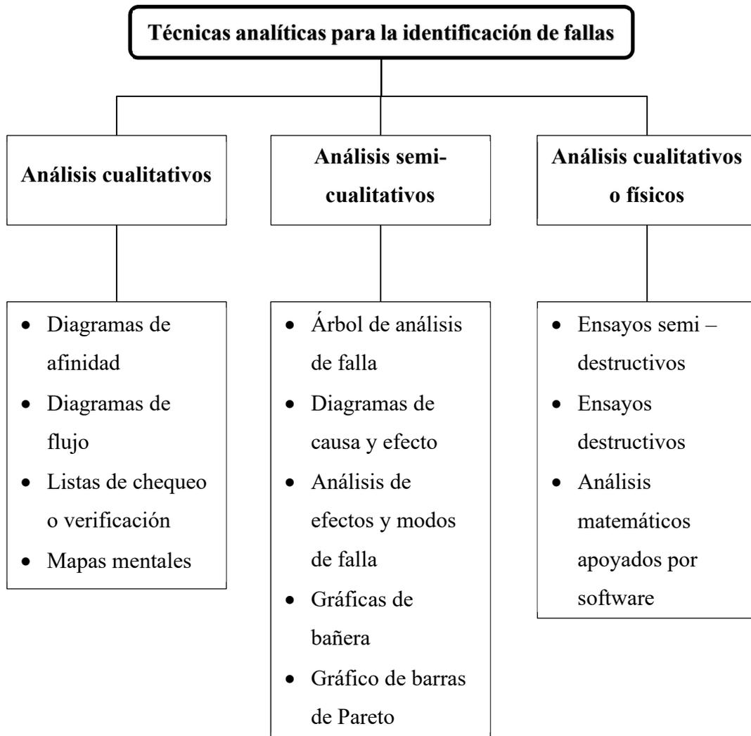
*Ilustración 3 Técnicas analíticas para la identificación de fallas*
