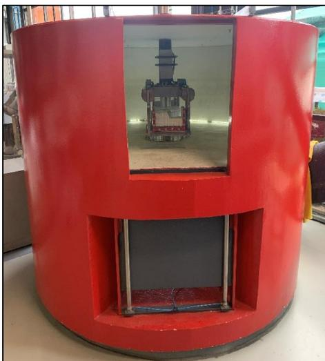
*Figura 29. Modelo instalado dentro de maquina centrífuga previo al inicio del vuelo. Fuente: Propia*
