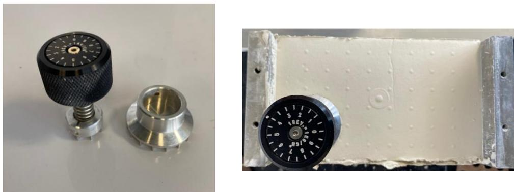
**Figura 30.** Ensayo de resistencia al corte no drenada con mini veleta. Fuente: Propia
