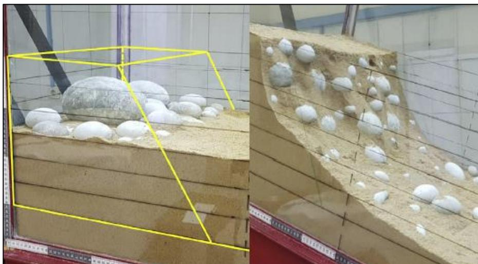
**Figura 9.** Modelos de Bimslopes a) preparación del modelo b) Resultado del ensayo. Fuente: (Khorasani et al., 2019)
