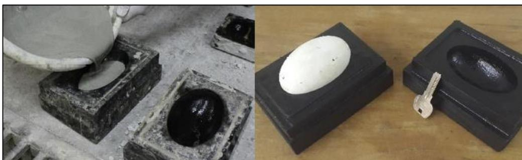
**Figura 8.** Construcción de bloques con mezcla de cemento, yeso y agua en molde elipsoidal. Fuente: (Khorasani et al., 2019)
