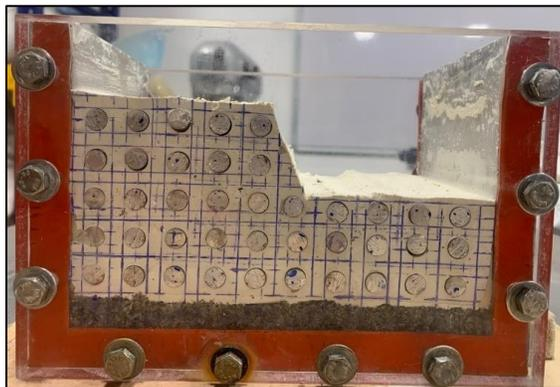
*Figura 27. Corte del talud y marcación de cuadrícula en cara frontal del modelo. Fuente: Propia*
