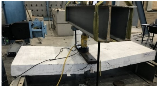
Fotografía 6. Falla losa CFRP-2
