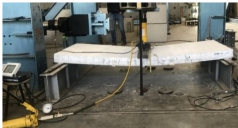
Fotografía 12. Falla por aplastamiento centro CFRP 5 (12X4)
