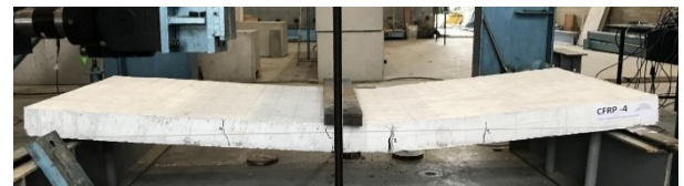
Fotografía 9. Fisuramiento y agrietamiento CFRP4).
