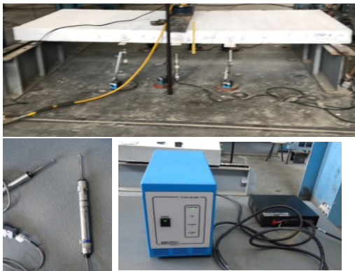
Fotografía 4. Montaje de 3 LDVT por cara.
