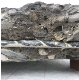
Fotografía 7. Detalle de falla adherencia CFRP-Concreto
