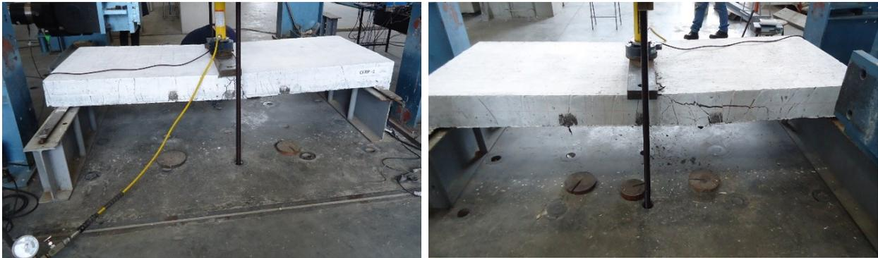
*Fotografía 20. Ensayo losa CFRP-1A, ver falla por compresión en la fibra superior*
