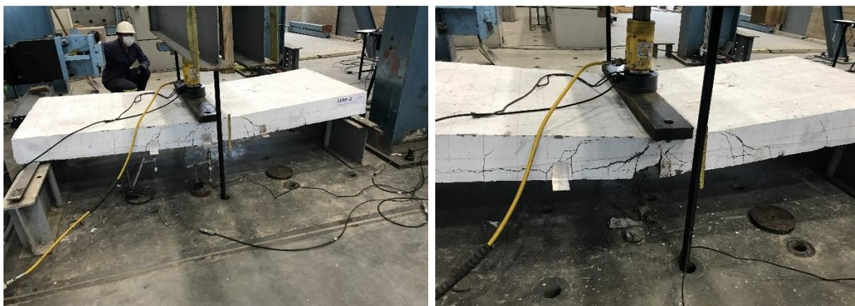
Fotografía 25. Ensayo losa CFRP-2, se observa la progresión de la fisuración de falla y deflexión en el centro de la luz, de foto izquierda a derecha
