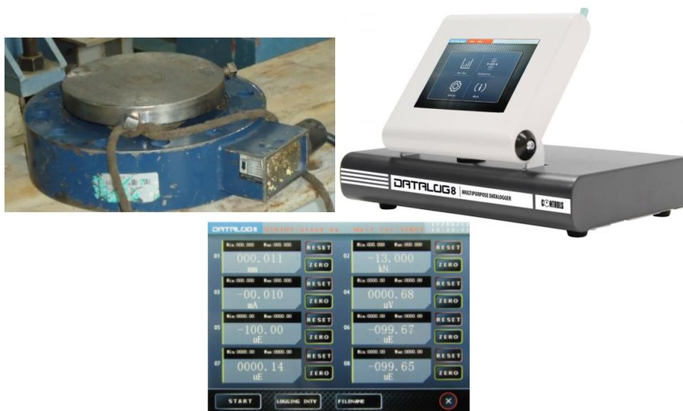
*Fotografía 11. Celda de carga Load Cell SL410-50T, Datalog 8, Display de control de carga.*
