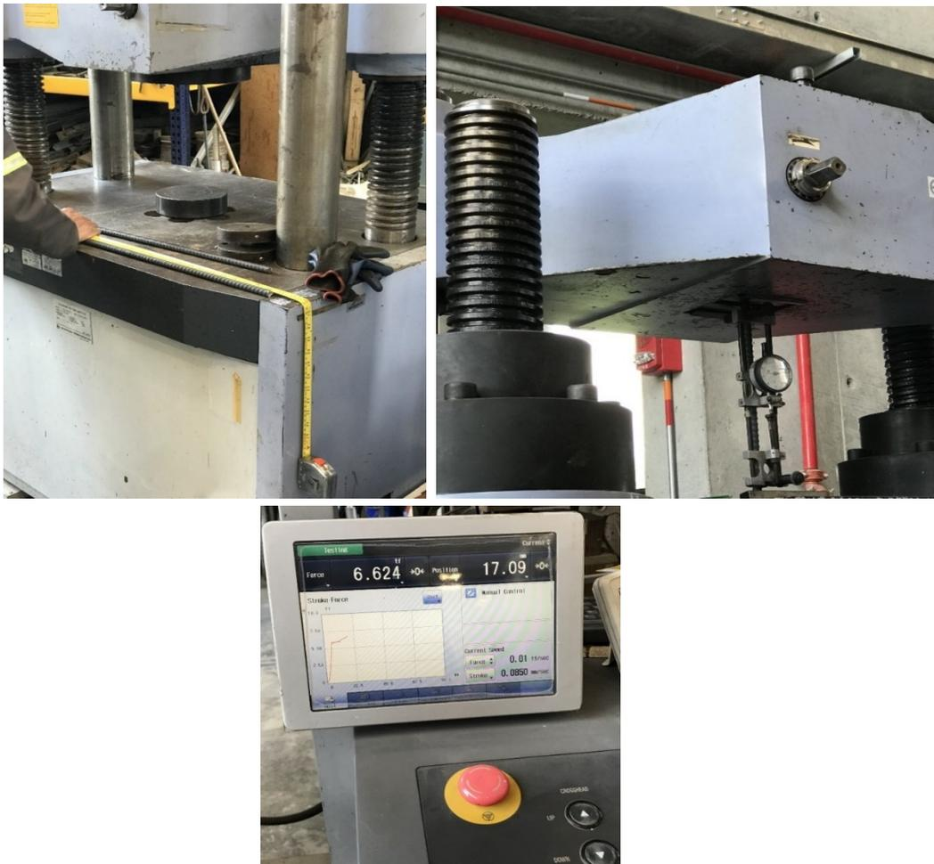
Fotografía 50. Ensayo de barras de acero A706 a tensión midiendo la deformación.
