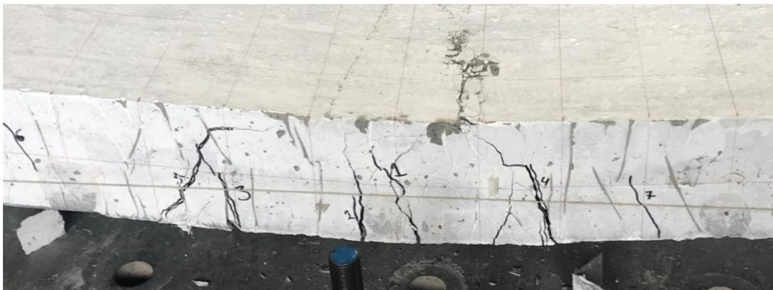
Fotografía 57. Fisuramiento losa A706-1, ciclo de carga a 75%.
