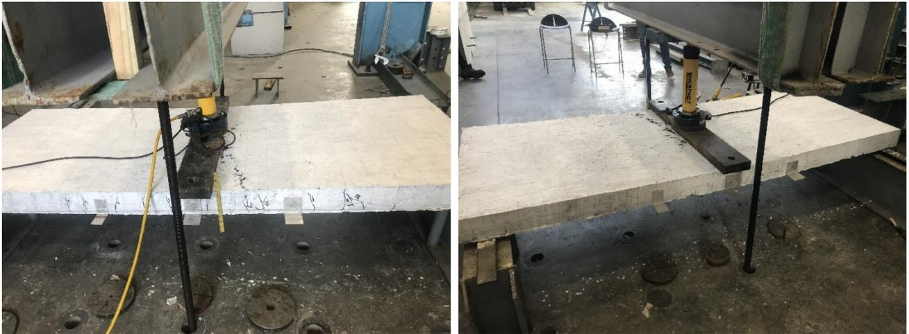
*Fotografía 76. Proceso de carga, deflexión del elemento CFRP-5, Tercer ciclo 75%*
