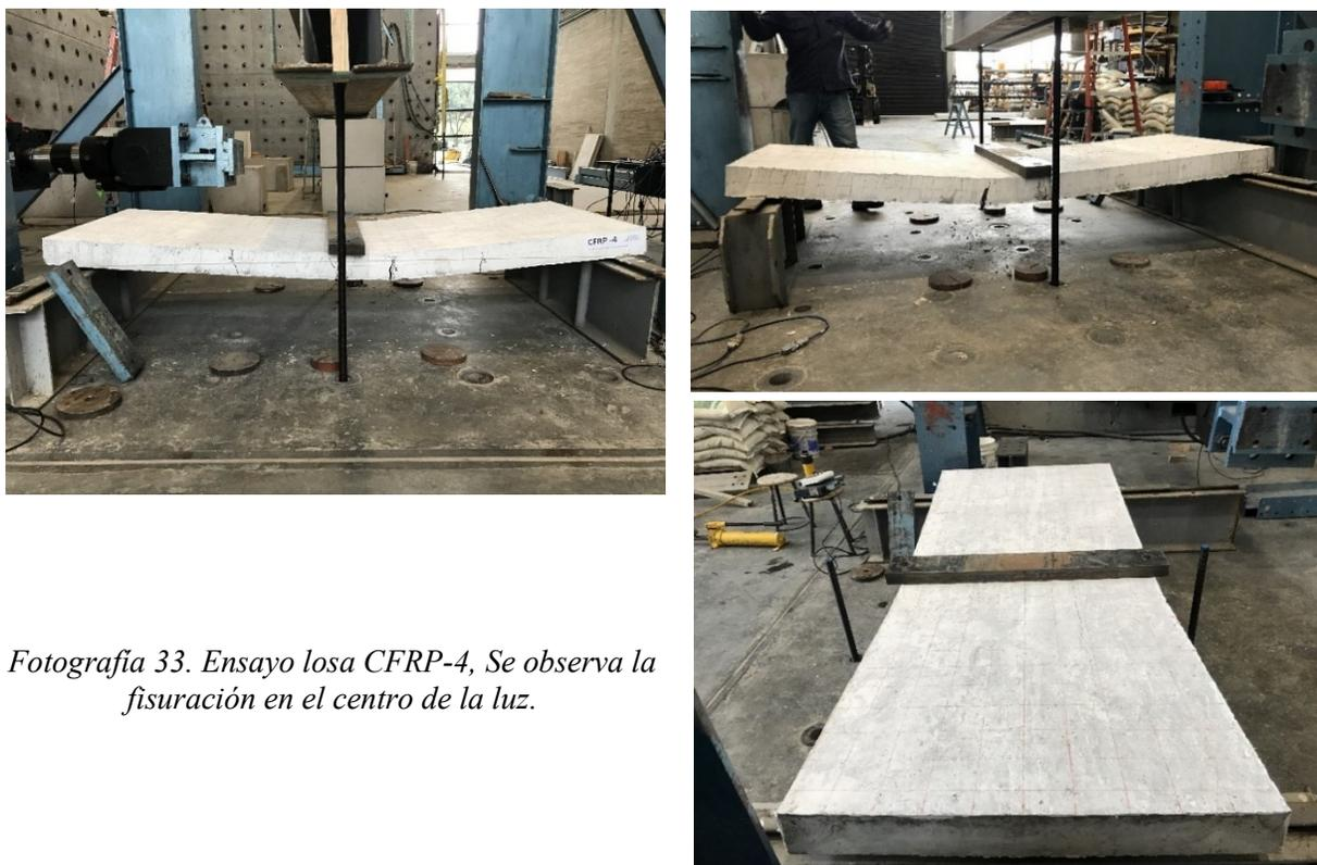
*Fotografía 33. Ensayo losa CFRP-4, Se observa la fisuración en el centro de la luz.*
