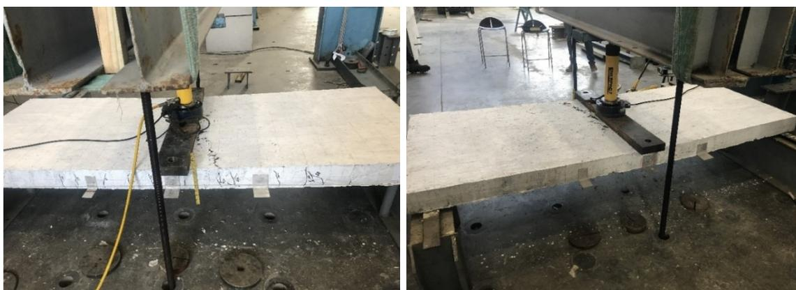
*Fotografía 38. Ensayo losa CFRP-5, Zona de aplastamiento de falla del concreto en el centro de la luz.*
