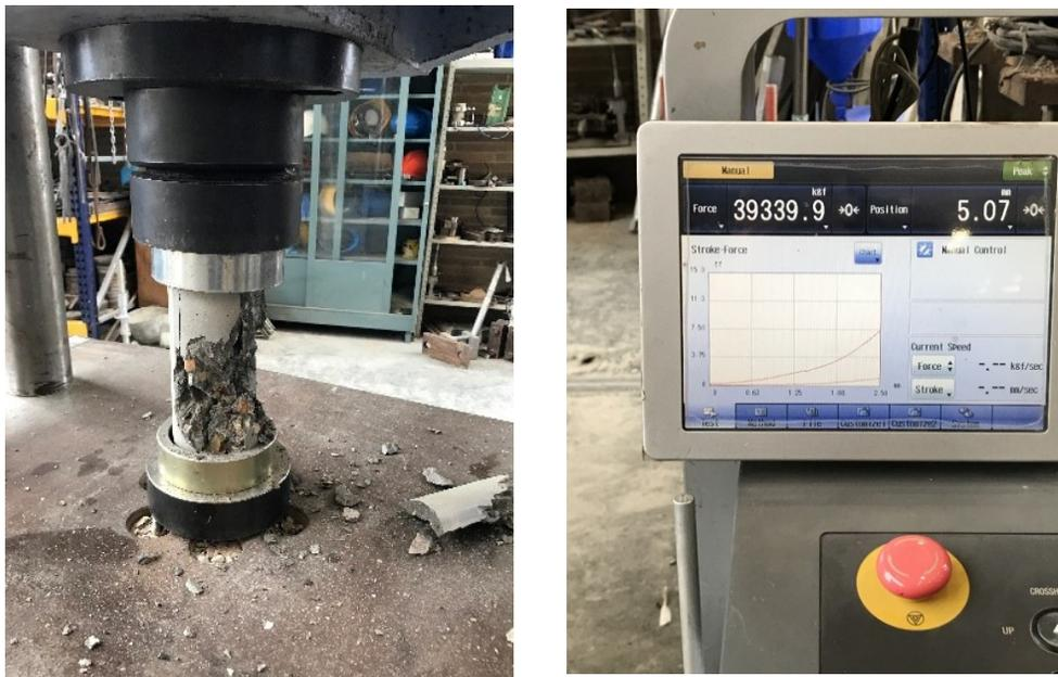
*Fotografía 55. Ensayo de cilindros de concreto*
