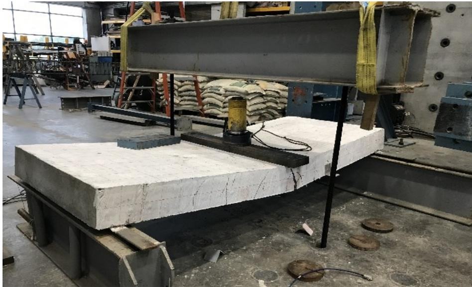
*Fotografía 46. El Modo de falla losa A706-1, fisuras en la zona a tensión.*
