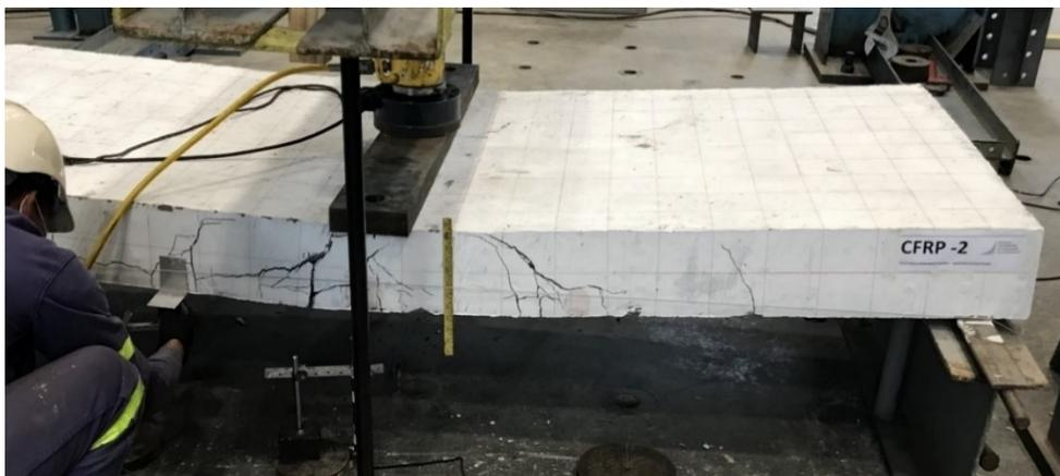
*Fotografía 23. Con hilo se mide deflexión del elemento, falla total 60,29 mm losa CFRP 2*
