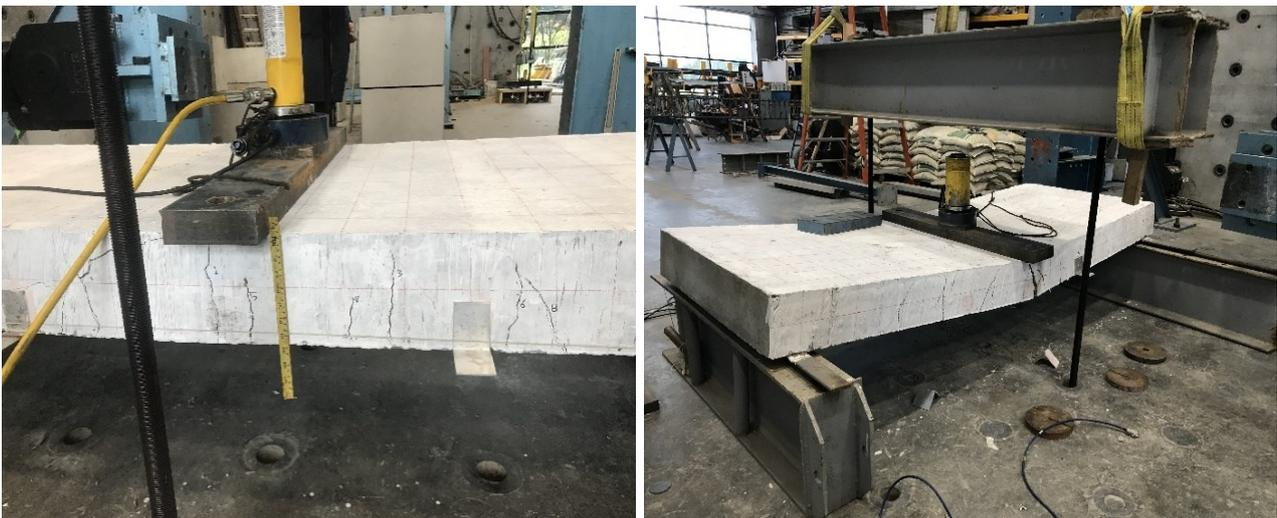
Fotografía 71. Deflexión del elemento CFRP-3 en ciclos 50 y 75%
