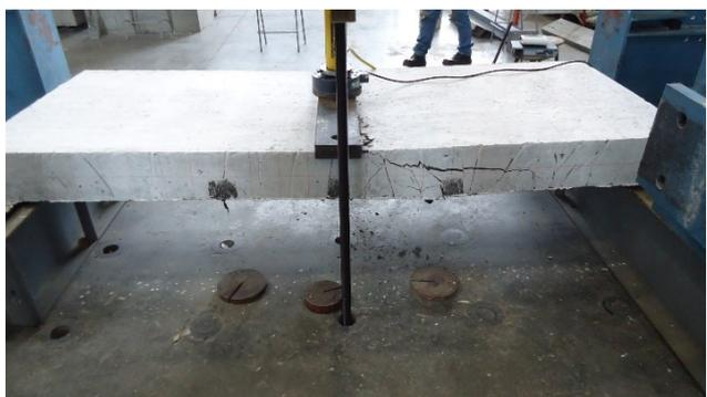
*Fotografía 62. Fisuración por Carga del elemento CFRP-2 (18X3)*
