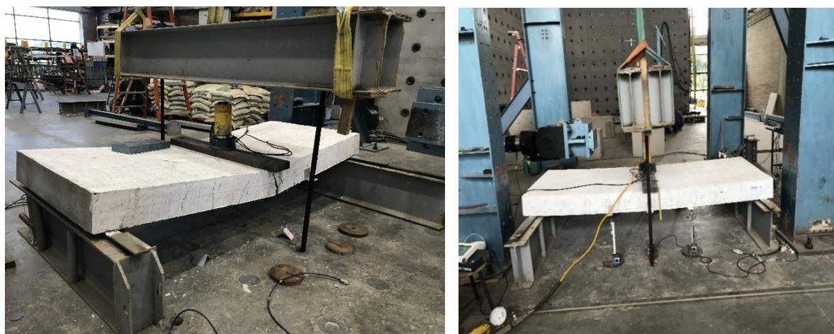
*Fotografía 65. Proceso de carga de la losa CFRP-2*
