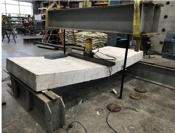
*Fotografía 59. Falla final de la losa A706-1 fracturamiento zona central.*
