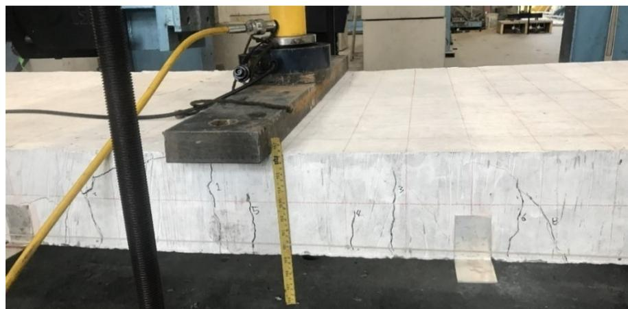
*Fotografía 28. Grietas de falla por flexión en la zona inferior de la losa.*
