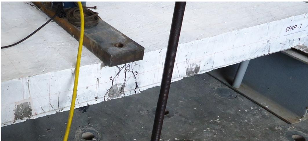
*Fotografía 16. Fisuración en la zona central en el momento de agrietamiento del CFRP-1A*
