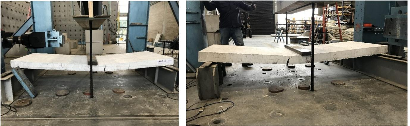
*Fotografía 72. Proceso de carga y deflexión del elemento CFRP-4*
