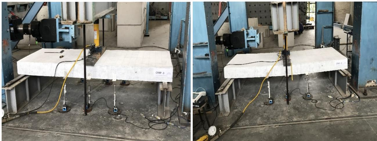
*Fotografía 69. Proceso de carga y deflexión del elemento CFRP-3*
