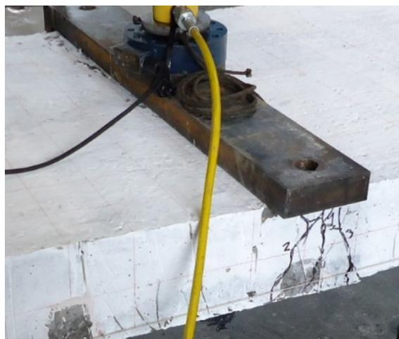
*Fotografía 60. Deflexión elemento y agrietamiento en centro de la losa CFRP-1A (18x2)*
