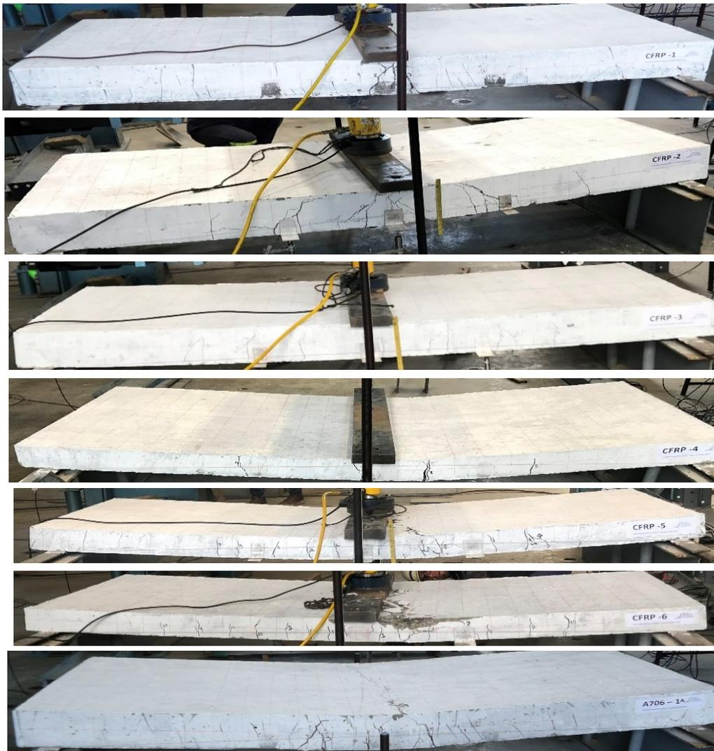
*Fotografía 49. Compilación de losas falladas*
