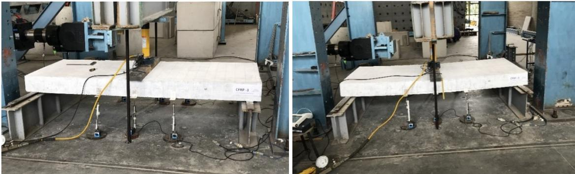
*Fotografía 30. Montaje para ensayo losa CFRP-3*
