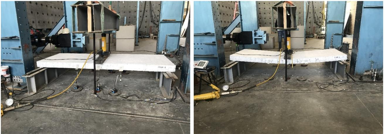
Fotografía 74. Proceso carga y deflexión elemento CFRP-5
