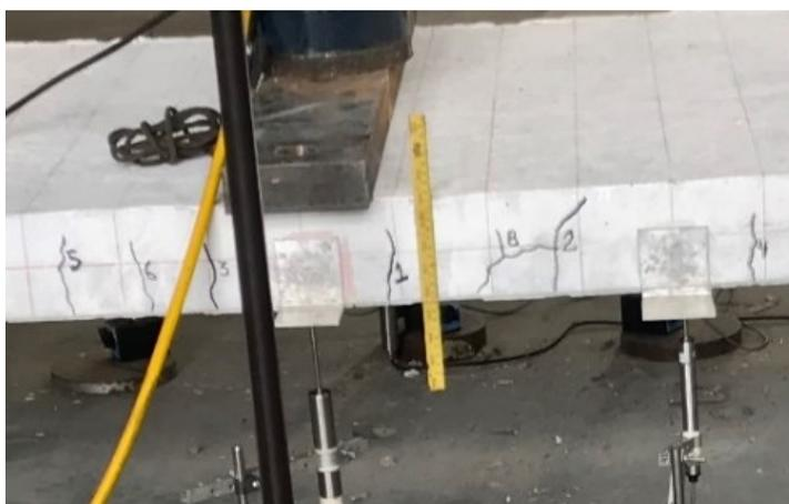
Fotografía 42. Falla por aplastamiento concreto en la sección zona central losa.
