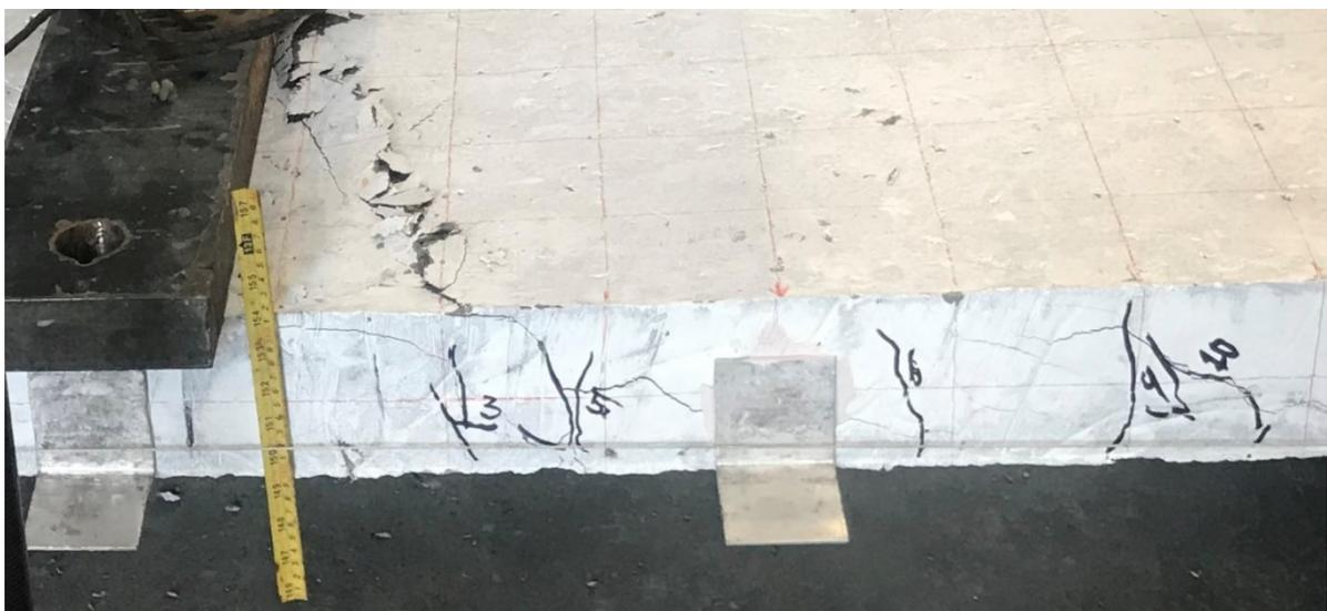
*Fotografía 77. zona central superior losa, falla por aplastamiento del concreto.*
