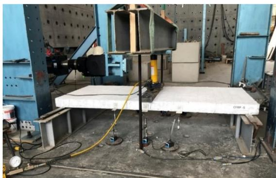
Fotografía 14. Montaje de equipos de ensayo: losas, gato hidráulico, celda de carga.
