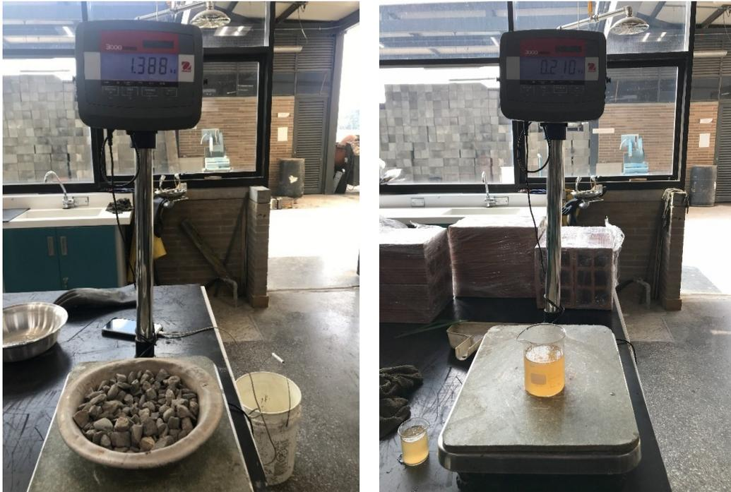
*Fotografía 51. Pesado de agregados y pesado de Plastificante Plastol 7000 (calibración de humedad)*
