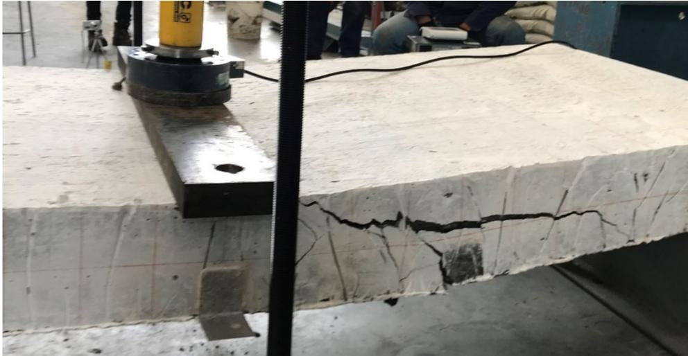
*Fotografía 18. Falla en la zona superior por aplastamiento del concreto.*
