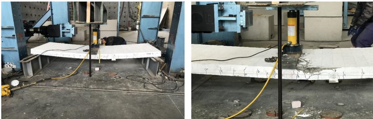
*Fotografía 45. Ensayo losa CFRP-6, ver fisuración en el centro de la luz.*
