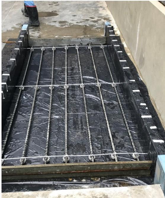
*Fotografía 9. Refuerzo losa CFRP-6*
