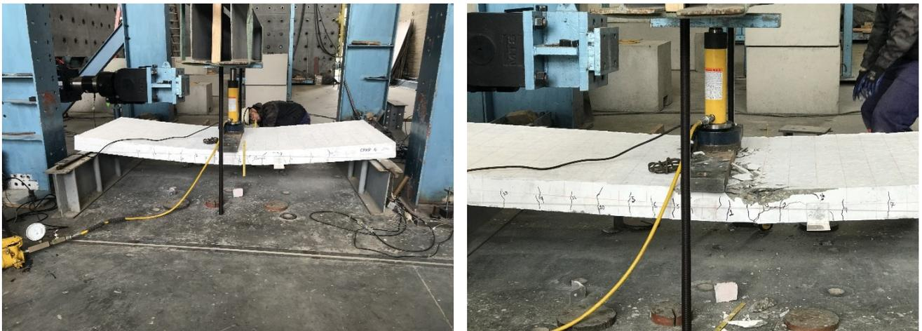
*Fotografía 81. Se retiran los LVDT pues su alcance se desbordo y se carga hasta la falla final*
