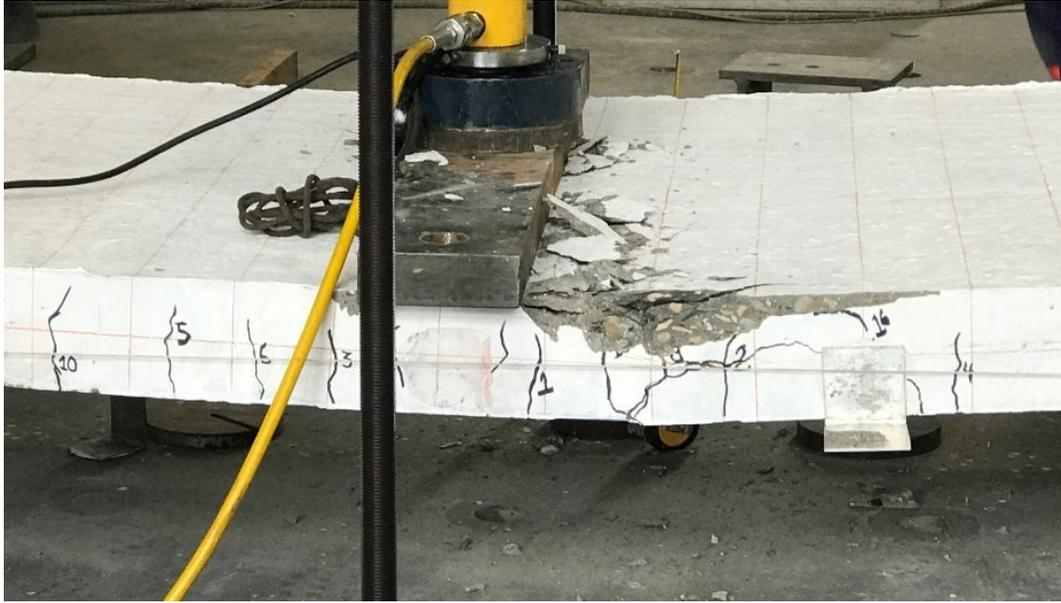
*Fotografía 43. Falla por aplastamiento concreto en la sección zona central losa.*
