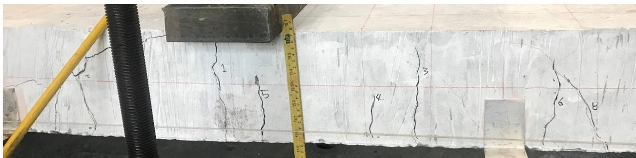
*Fotografía 70. Fisuración causada por la carga del elemento CFRP-3*
