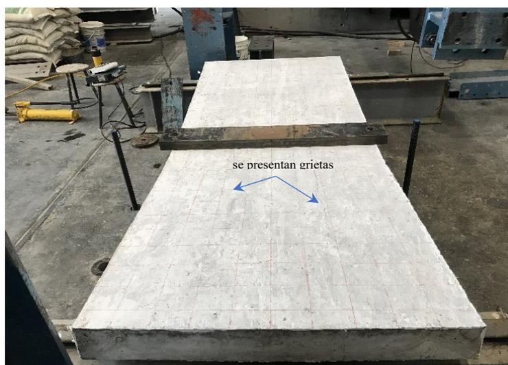
*Fotografía 73. Ciclo 50% de carga, fisuras longitudinales sobre la cara superior losa*
