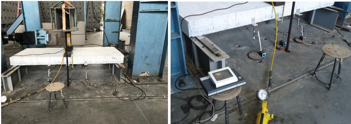
*Fotografía 19. Ensayo losa CFRP-1A, ver fisuración en el centro de la luz.*
