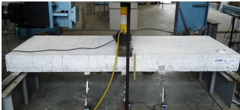
Fotografía 15. Montaje para el ensayo de la losa CFRP-1A (18X2)
