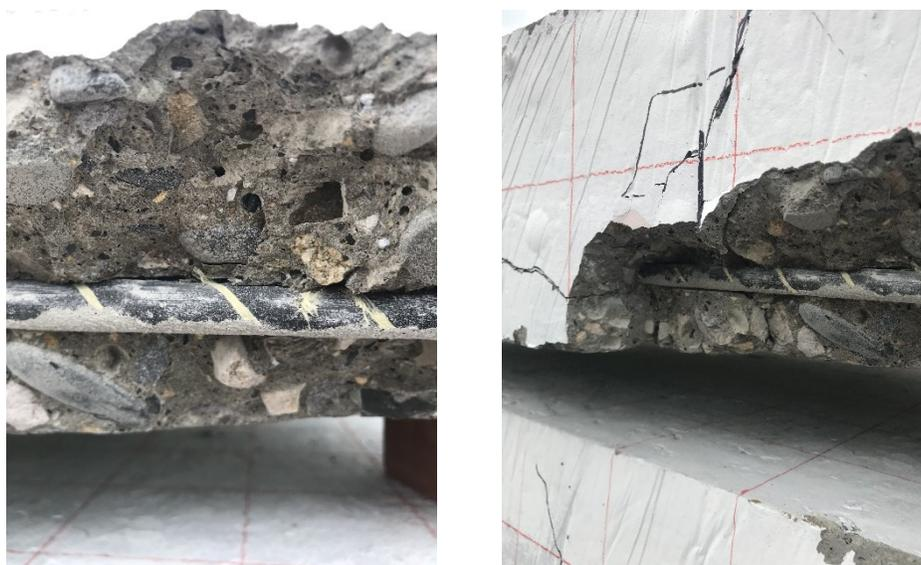
*Fotografía 27. Detalle de falla de adherencia de la Barra de CFRP con el concreto*
