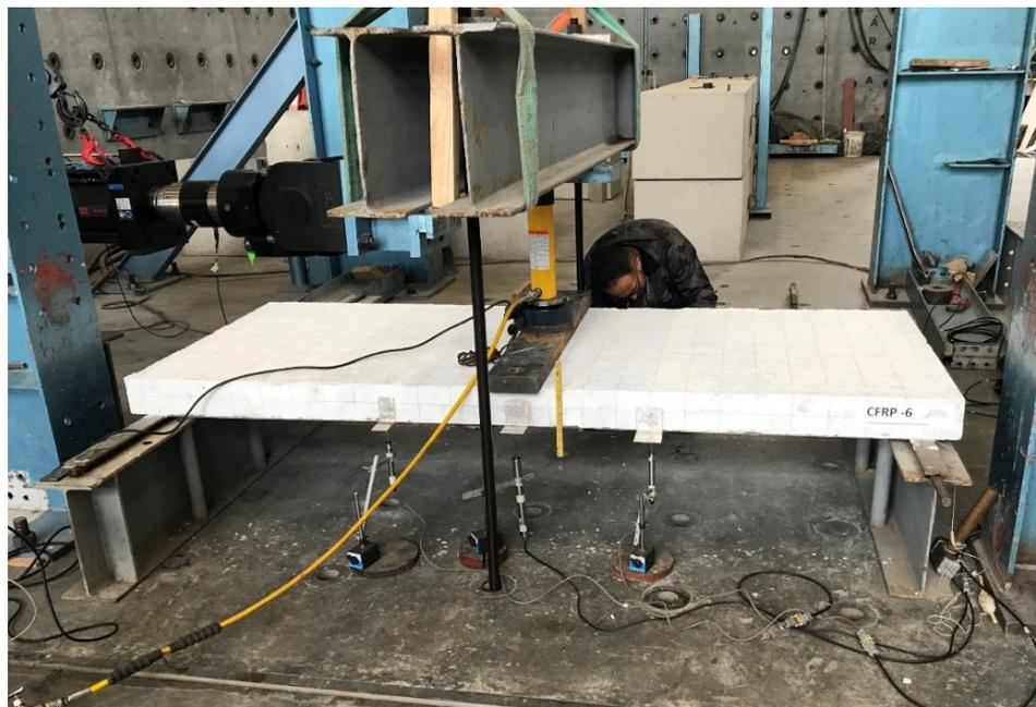
*Fotografía 39. Montaje para ensayo de losa CFRP-6 (12X7), LDVT en posición delantera.*
