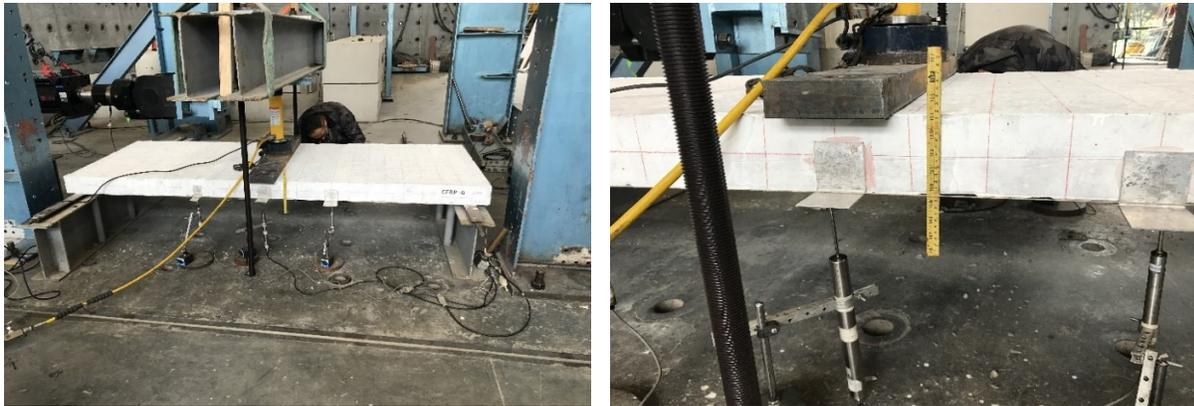
*Fotografía 44. Montaje para el Ensayo losa CFRP-6.*
