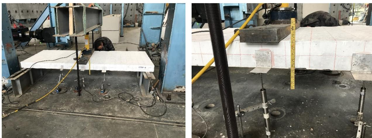
*Fotografía 79. Segundo ciclo, carga al 50%, fisuras continúan siendo más anchas.*
