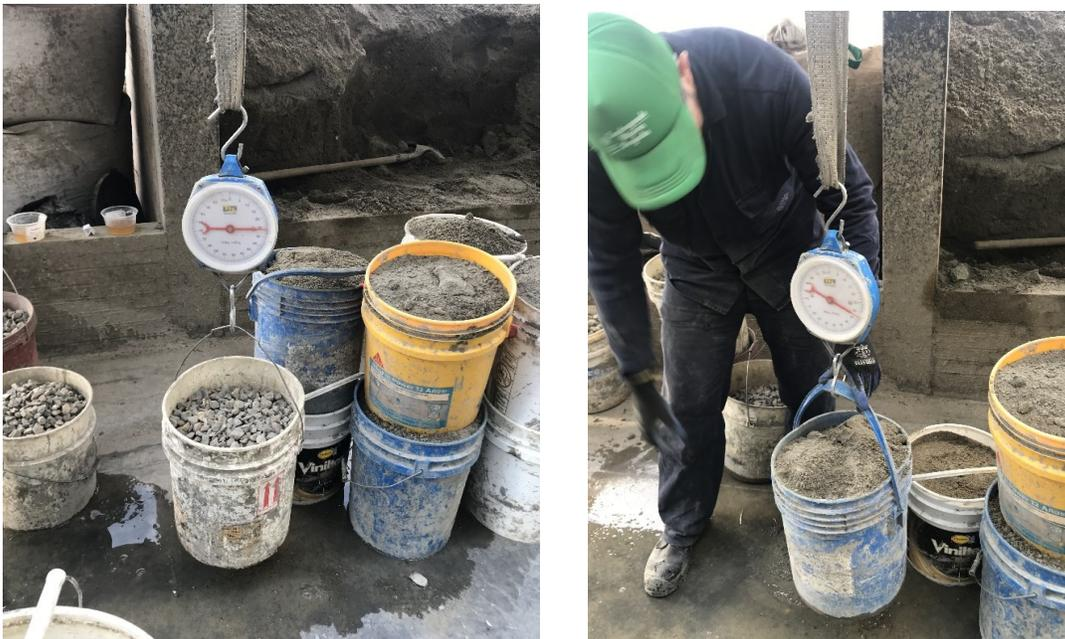
*Fotografía 52. Pesado de los agregados y suministro del aditivo plastificante.*
