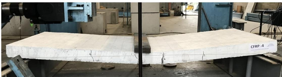
*Fotografía 32. Fisuramiento y agrietamiento final de la losa CFRP4 (12X2).*
