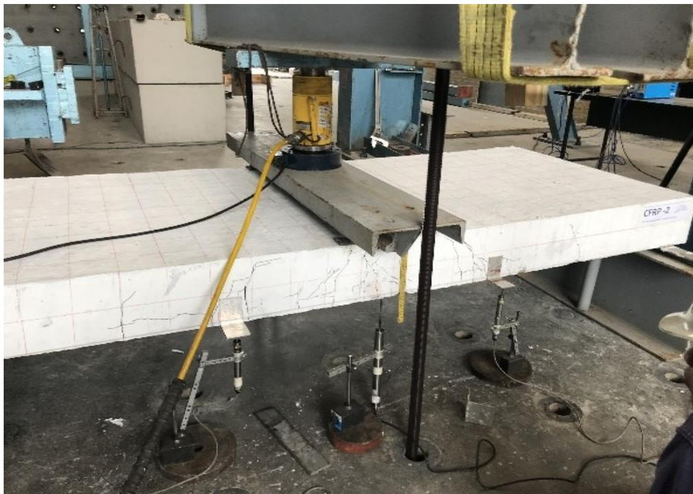
*Fotografía 21. Falla de la losa CFRP-2 (18X3) con pérdida de material en el centro.*
