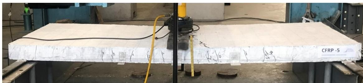
Fotografía 36. Agrietamiento fibra central a tensión losa CFRP5 (12X4). Momento de falla
