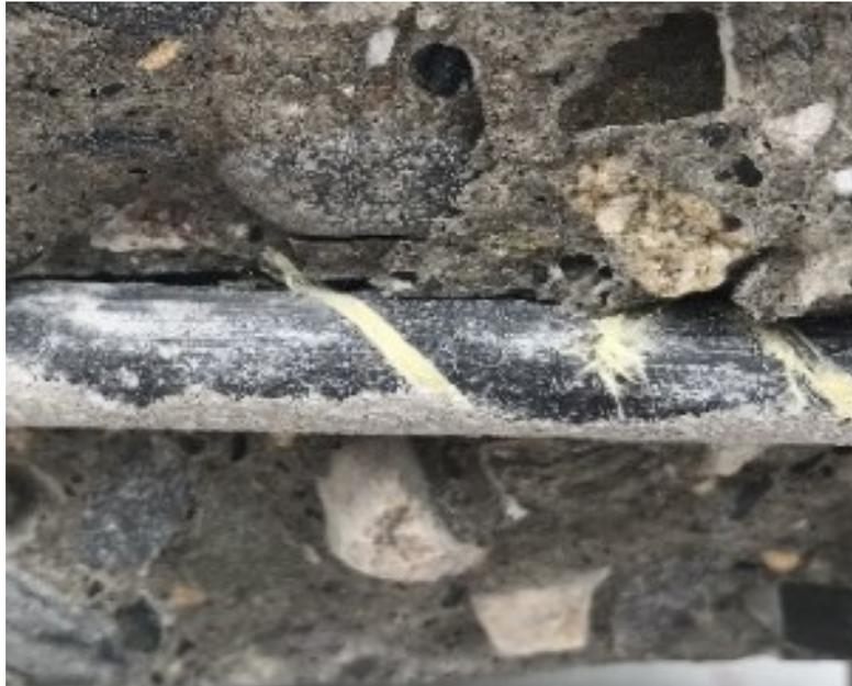
*Fotografía 67. Rayaduras superficie barra de CFRP por deslizamiento de la barra de CFRP debida a la pérdida de adherencia.*
