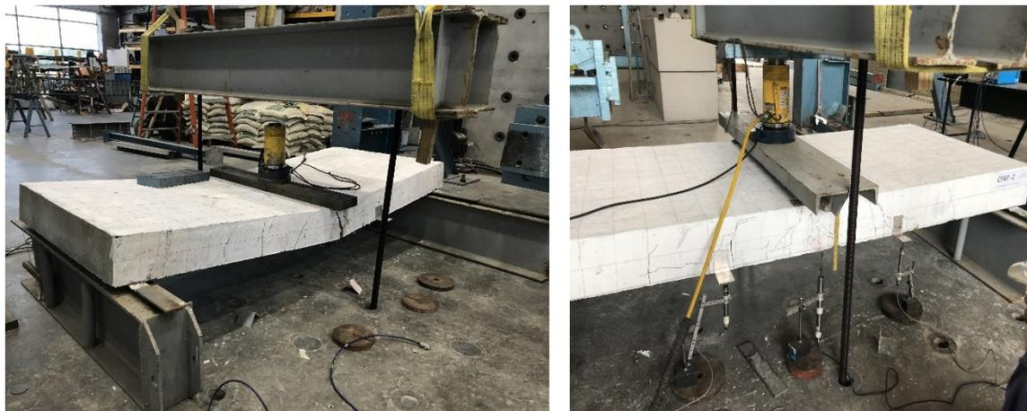
*Fotografía 26. Ensayo losa CFRP-2, ver fisuración en el centro de la luz.*
