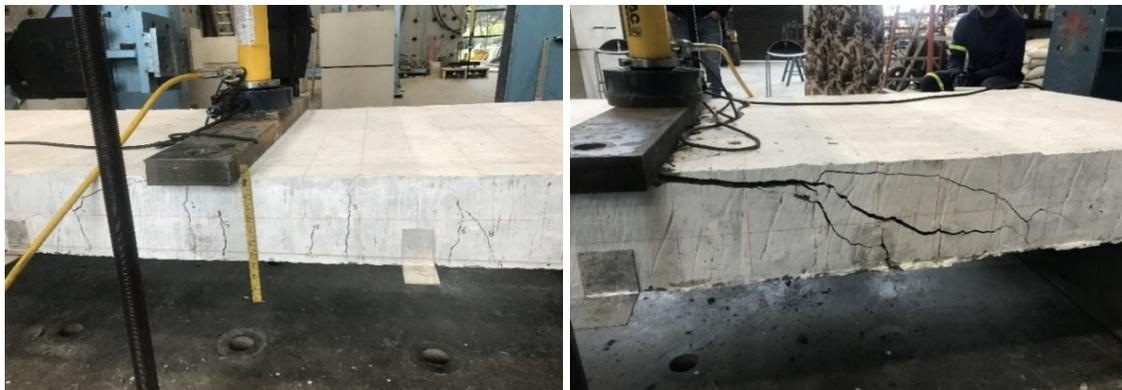
*Fotografía 31. Fisuración notable frontal y posterior en la losa CFRP-3*
