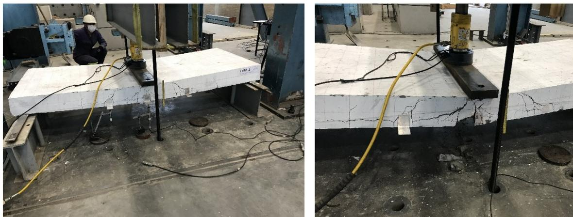
*Fotografía 64. Fisuración adelante y atrás de la losa CFRP-2*
