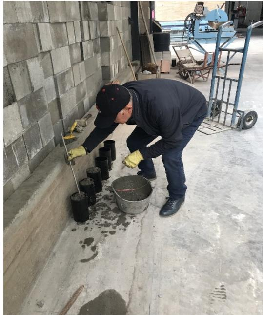
*Fotografía 2. Mezcla de concreto, vaciado en formaleta y cilindros*
