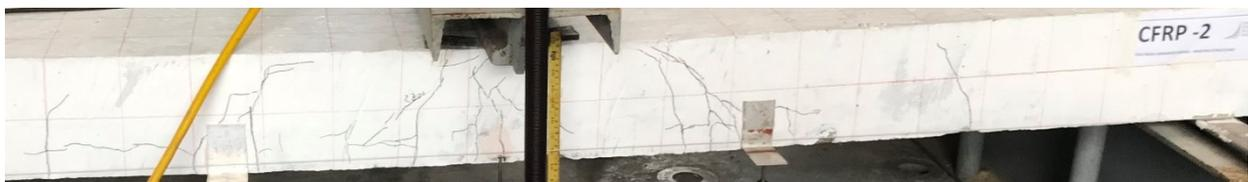
*Fotografía 63. Fisuración en proceso de carga del elemento CFRP-2 (18x3)*
