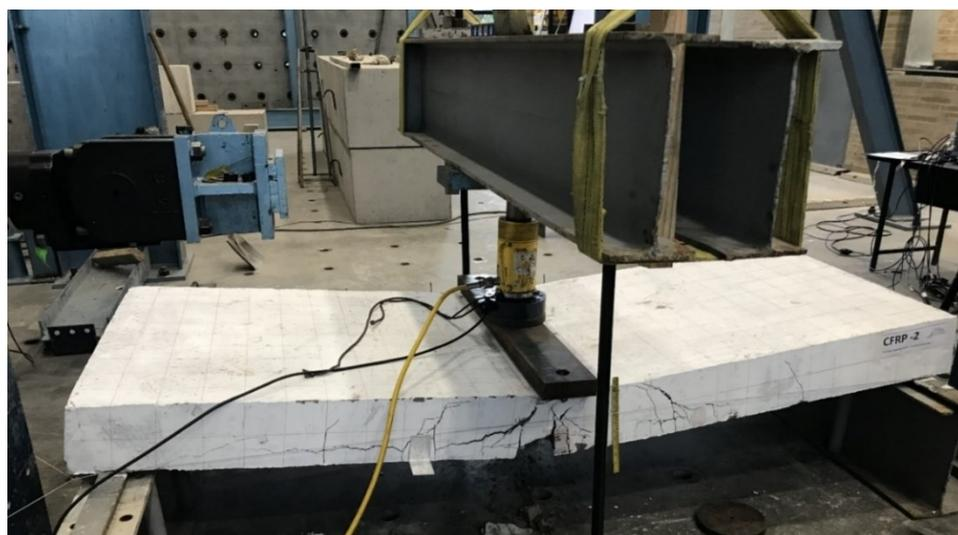
*Fotografía 22. Falla de la losa CFRP-2 (18X3) con pérdida de material entre fisuras centrales*
