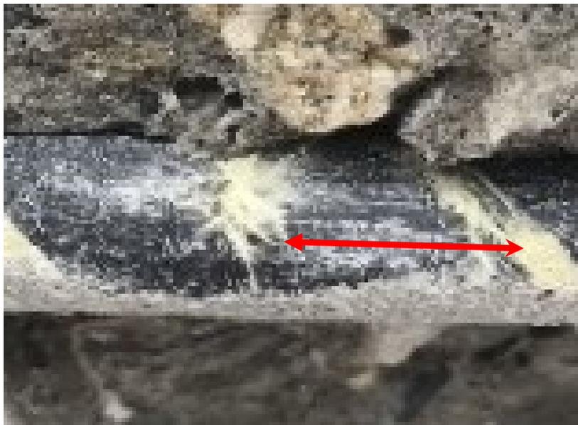
*Fotografía 68. Imagen aumentada de la foto anterior donde se ve el arrancamiento de la fibra amarilla del refuerzo CFRP, falla por adherencia en la zona de contacto Refuerzo- Concreto*
