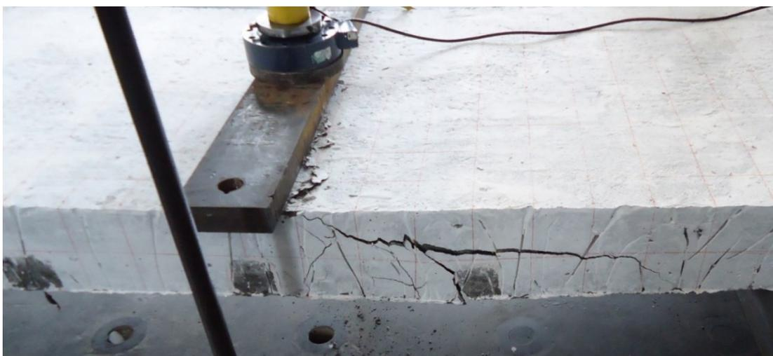
*Fotografía 17. fisuramiento en la zona posterior de la losa CFRP-1A*
