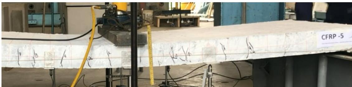
Fotografía 34. Fisuración segundo ciclo 50% carga 1600 kg
