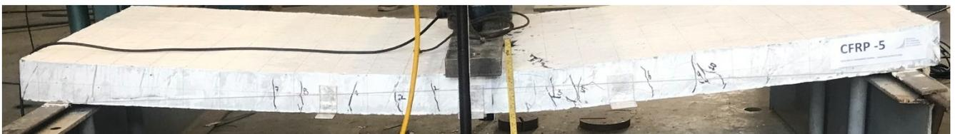
Fotografía 75. Ciclo 50% de carga, aparecen fisuras elemento CFRP-5
