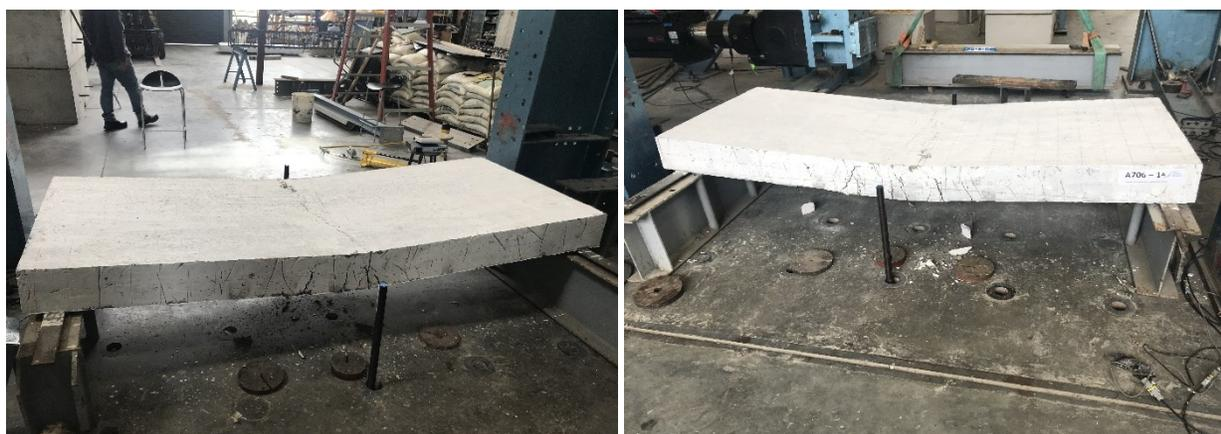
Fotografía 48. Ensayo losa A706-1, ver fisuración en el centro de la luz.
