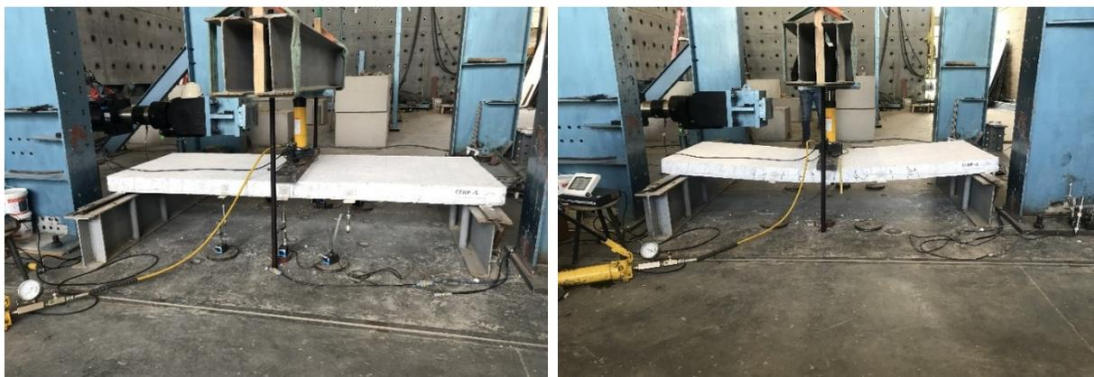
*Fotografía 37. Ensayo losa CFRP-5, ver fisuración en el centro de la luz.*
