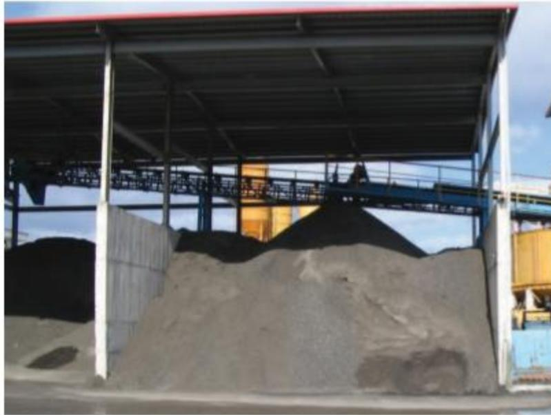
*Figura 7 Pila cónica cubierta adecuadamente-Randy C. West*
