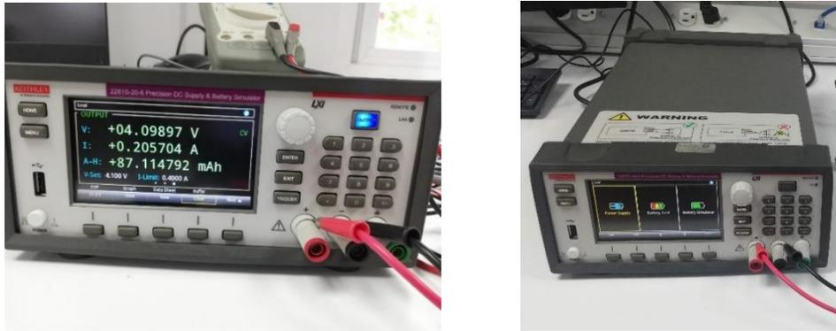
Fig. 6 Precision DC Supply and Battery Simulator, dispositivo para prueba de rendimiento de baterías.
