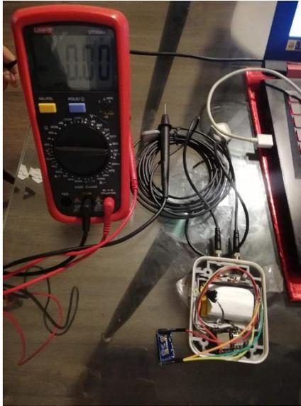
*Fig. 10 Prueba de rendimiento del sistema con batería de polímero de litio integrada*
