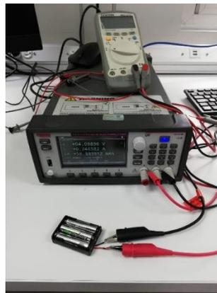
Fig. 7 Prueba de rendimiento de baterías
