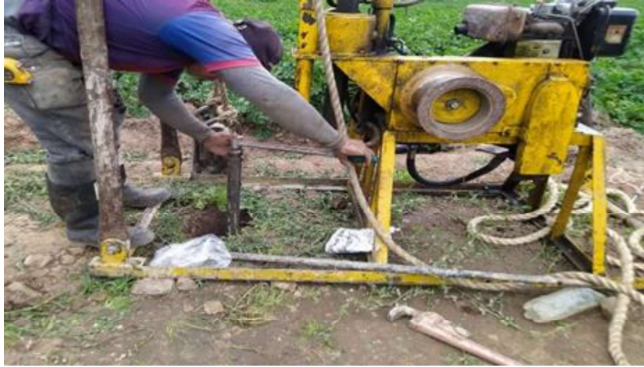
Figura 34. Ejecución del ensayo de veleta de campo.
