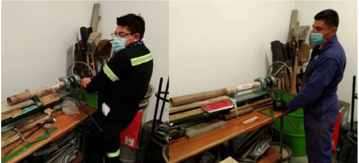
Figura 38. Extracción de muestras de los tubos Shelby realizada en la Escuela de Ingeniería Julio Garavito.
