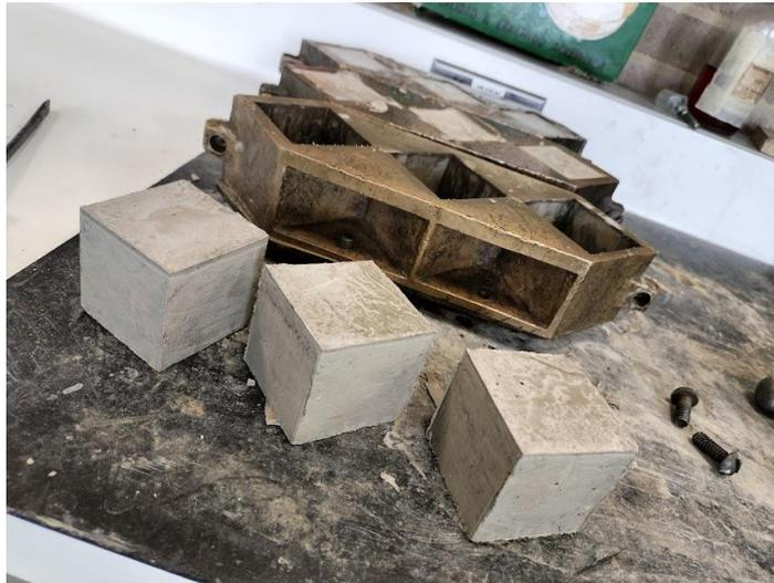
*Ilustración 2. Cubos de mortero para ensayos de compresión.
