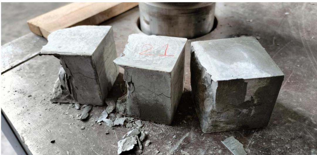
*Ilustración 25. Falla de ensayo 21. Con relación A/C 0.30 a los 28 días. Fuente: Propia.*
