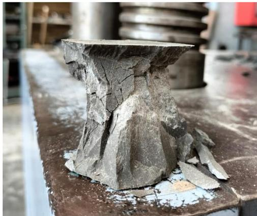
Ilustración 22. Falla de ensayo 19. Con relación A/C 0.35 a los 28 días. Fuente: Propia.
