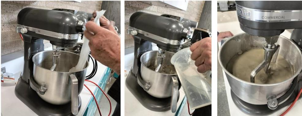
*Ilustración 8. Adición de cemento, agua y reposo de la unión. Fuente: Propia*
