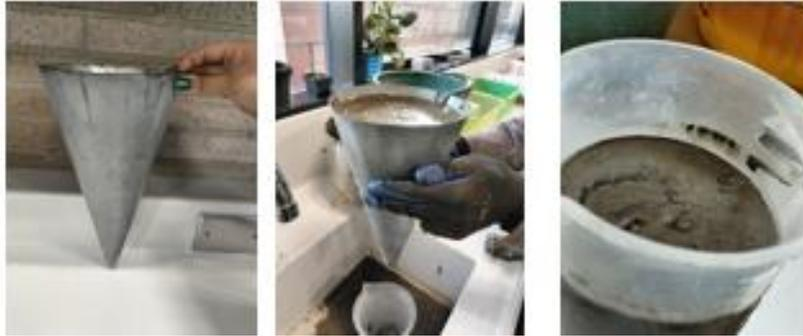
Ilustración 11. Ensayo de fluidez. Fuente: Propia
