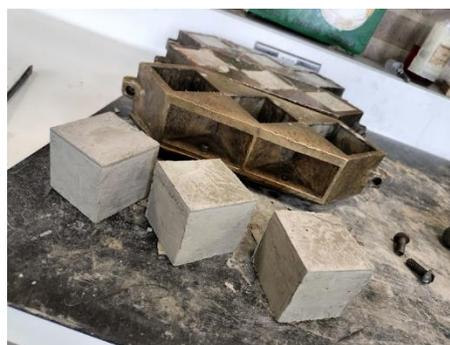
*Ilustración 14. Cubos para el ensayo de compresión.*
