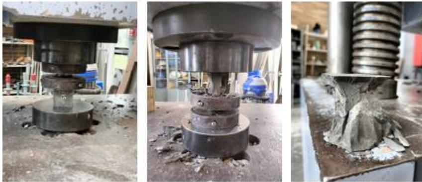
Ilustración 17. Proceso de falla en la máquina de compresión. Fuente: Propia
