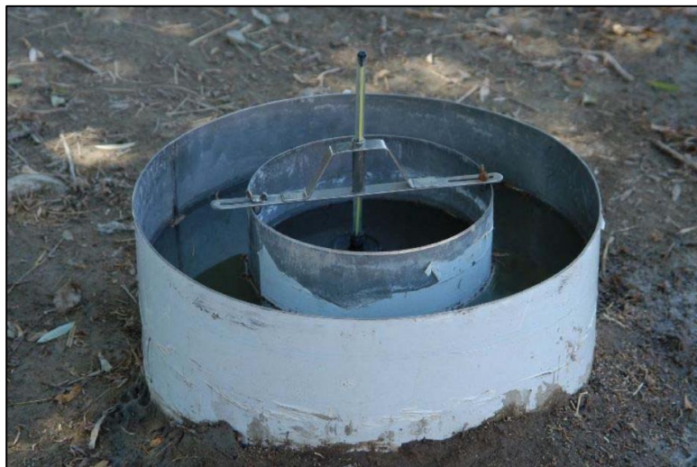
Fotografía 1. Montaje infiltrómetro de doble anillo
