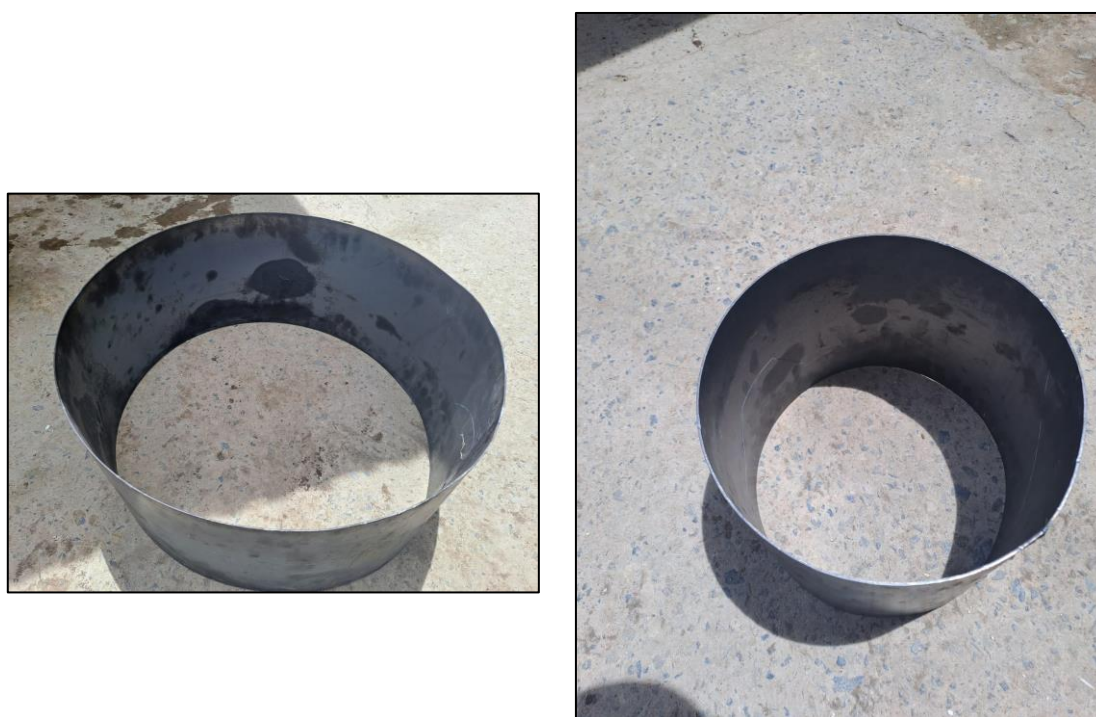
Fotografía 2. Anillos prueba de infiltración.
