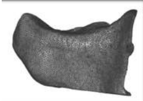
Figura 12. Modelo 3D integrando porosidad de 200 micrómetros por medio del software nTopology
