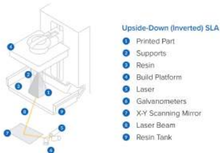
Figura 7. Guia de componentes de impresora SLA de Formlabs. [55]
