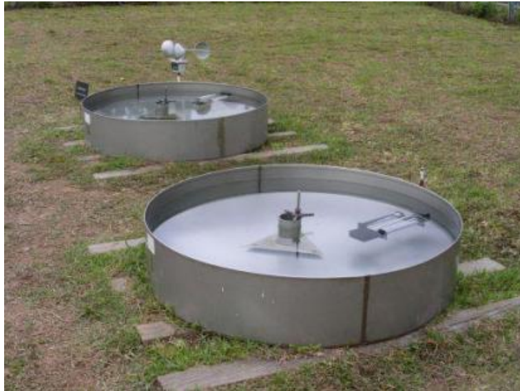
Fotografía 4-1 Tanque de evaporación clase A
