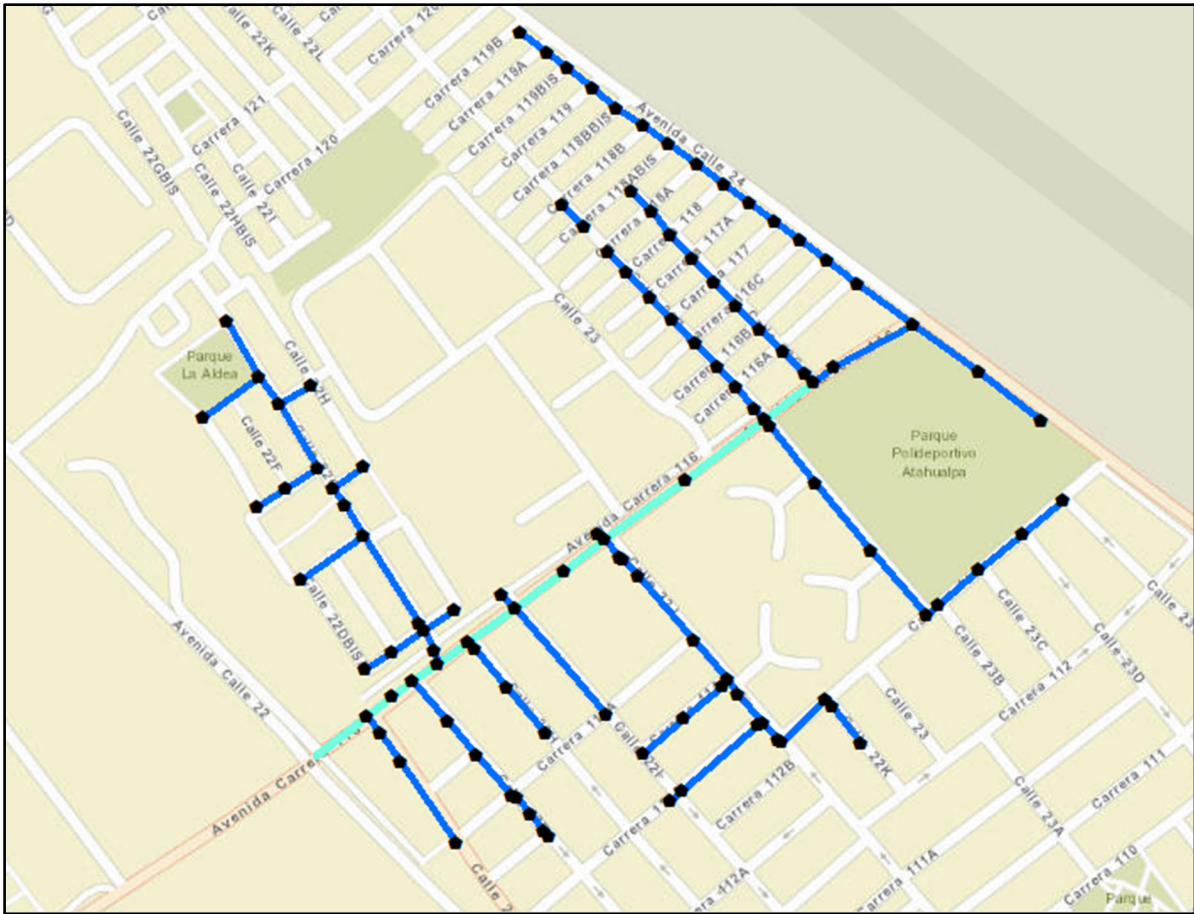
Ilustración 15. Sistema de alcantarillado pluvial actual.
