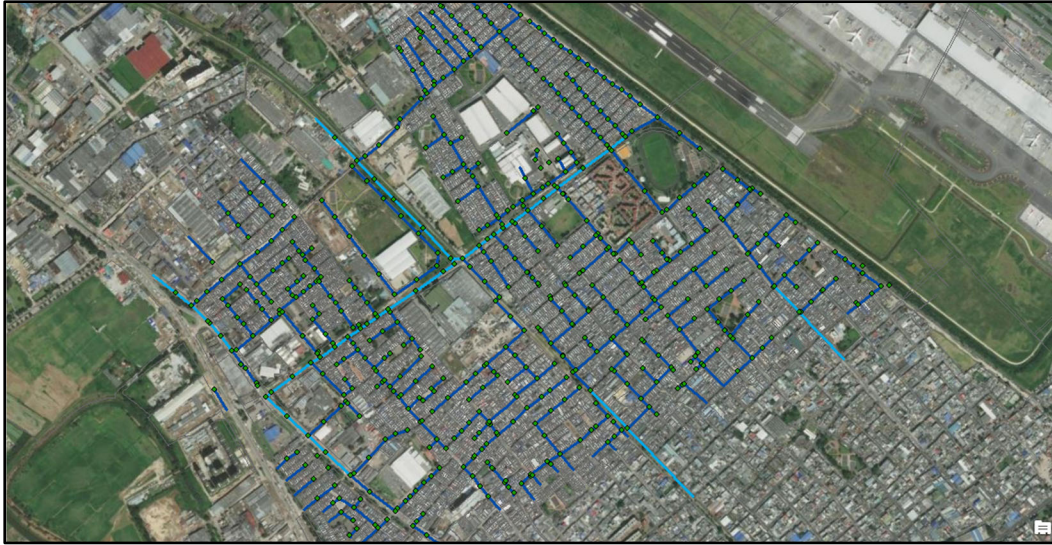
Ilustración 14. Alcantarillado pluvial existente.
