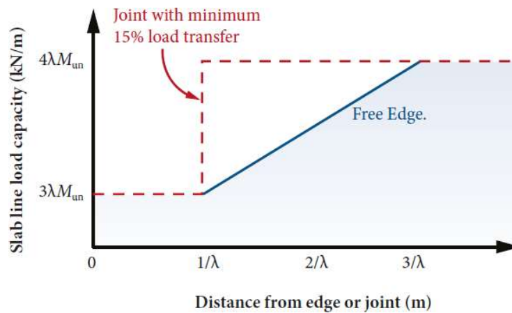
Figura 2.18 Capacidad de carga para cargas lineales cerca de bordes libres o juntas
