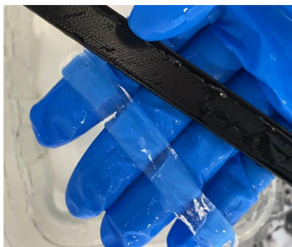
Ilustración 21. Molde y probetas de gel para prueba de tensión uniaxial.
