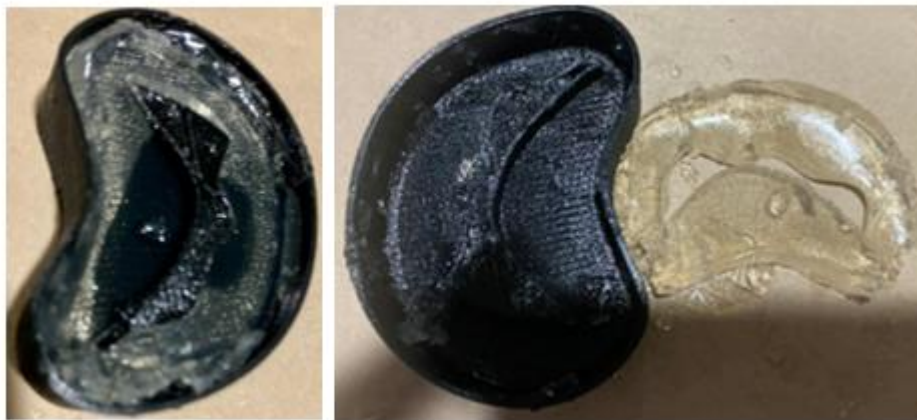
Ilustración 24. Modelo impreso de molde de válvula mitral.
