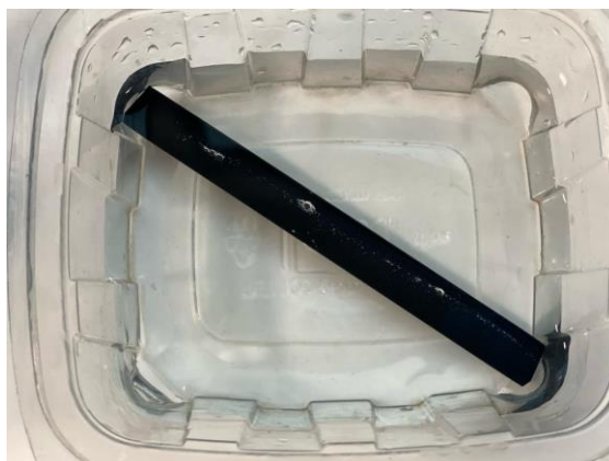
Ilustración 20. Probeta de gel de colágeno + alginato de sodio durante el método por inmersión, sumergida en cloruro de calcio.
