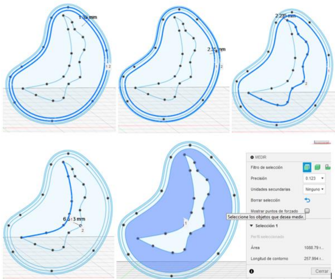
Ilustración 22. Medida geométrica del primer modelo de válvula mitral, las medidas se encuentran en milímetros.
