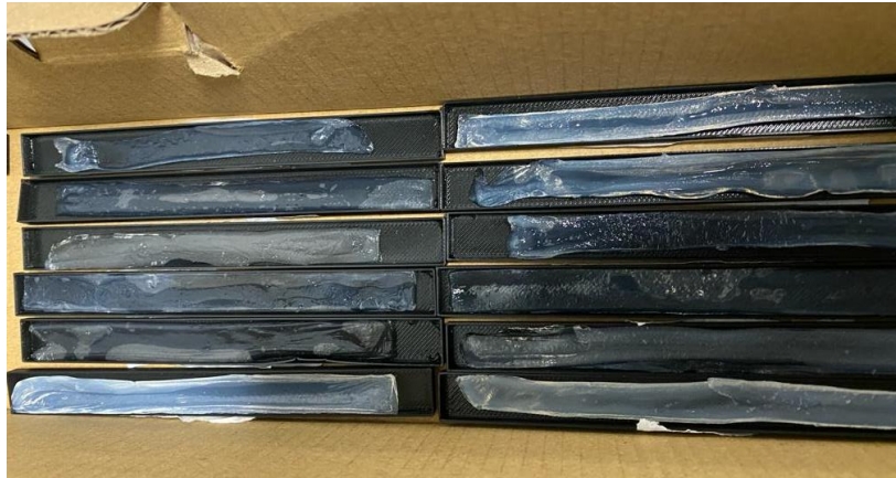
Ilustración 11. Probetas almacenadas para pruebas de tensión uniaxial.
