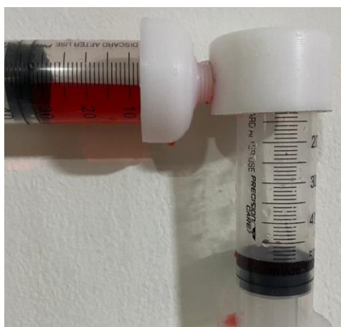
Ilustración 33. Banco de pruebas. Fluido en la jeringa horizontal (aurícula izquierda).
