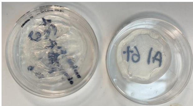
Ilustración 25. Membrana de alginato al 6% + colágeno al 3% y Membrana de alginato al 3% + colágeno al 3% en cajas de Petri.
