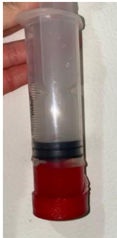
Ilustración 35. La jeringa vertical (ventrículo izquierdo) se ubica en dirección vertical inversa para verificar que no pase el fluido a través de la válvula.
