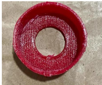
Ilustración 31. Arandela de sostén para las membranas de gel de alginato + colágeno. (cumple una función similar a la del anillo mitral)
