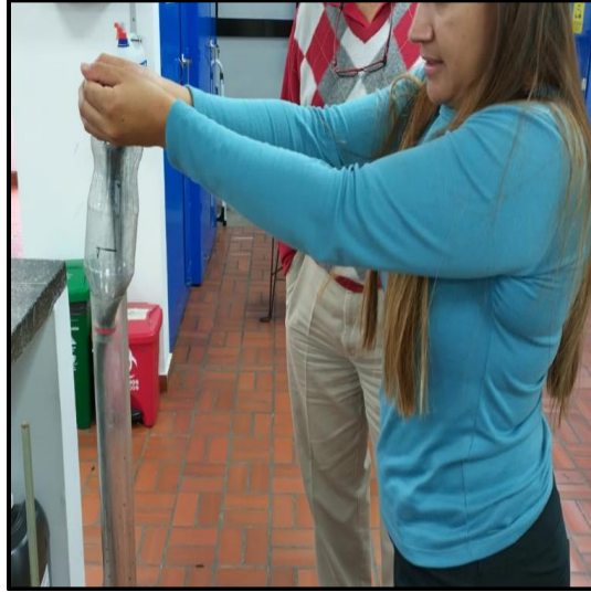
Ilustración 5-13. Llenado de la probeta con Material Filtrante.
