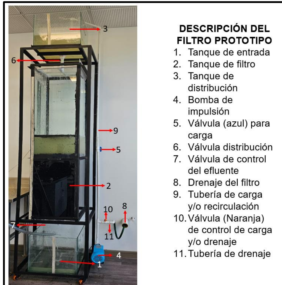
Ilustración 5-1. Filtro percolador piloto.
