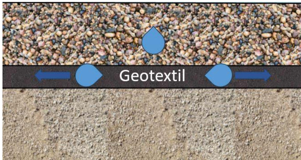
Figura 21: Efecto de capilaridad dentro de un geotextil tejido (elaboración propia)
