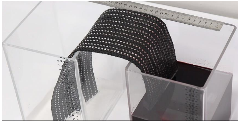
Figura 43: Ensayo de conductividad hidráulica (Pavco Wavin geosintéticos)
