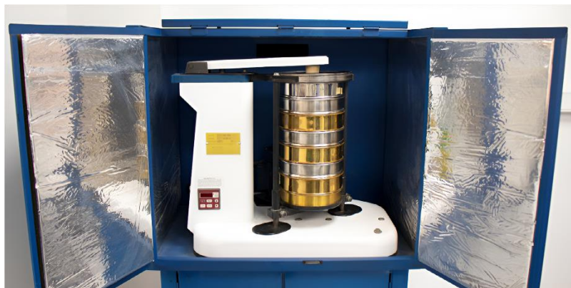
Figura 45: Equipo para ensayo de tamaño de abertura aparente TAA (Pavco Wavin geosintéticos)
