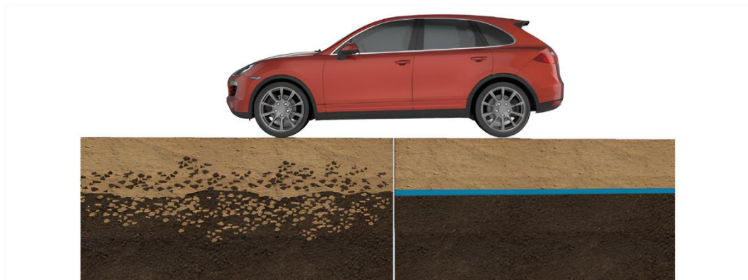
Figura 23: Geotextil tejido para separación de subrasantes (Diseño de Infraestructura con Geosintéticos, 2021, p.139)
