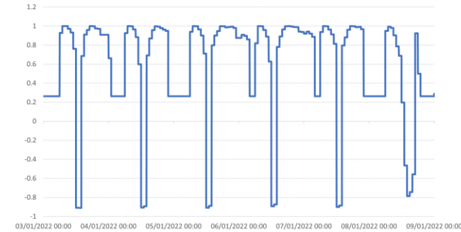
Figura 19. Factor de potencia de la instalación eléctrica con generación fotovoltaica corrigiendo los parámetros de calidad de energía con la instalación de un SVG.
