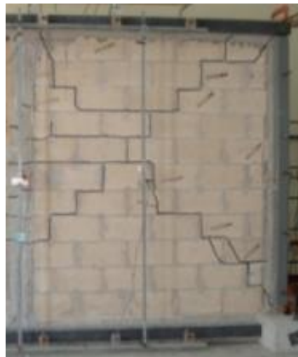
Ilustración 11. Falla por deslizamiento. Fuente [27]
