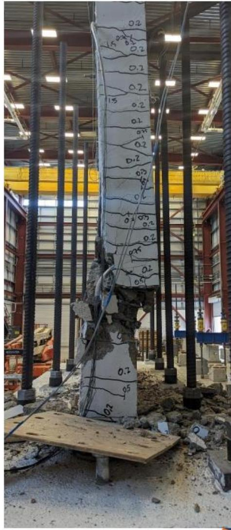
Ilustración 119 – Fallo por compresión/corte fuera del plano espécimen prefabricado. Fuente: (Neupane, 2023)
