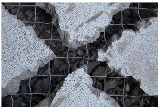
Ilustración 46 – Modo de falla por fractura del refuerzo horizontal en espécimen robusto con refuerzo en malla electrosoldada. Fuente: (Hube et al., 2020)
