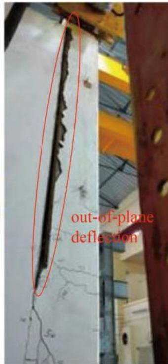
Ilustración 118 – Deflexión fuera del plano espécimen prefabricado con doble panel. Fuente: (Singhal et al., 2021)
