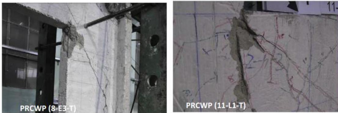
Ilustración 58 – Aplastamiento del concreto en las esquinas de las aberturas. Fuente: (Todut et al., 2014)
