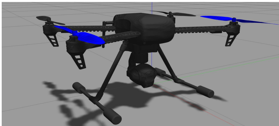
Figura 47. UAV con carga útil de cámara gimbal usado en el proyecto.
