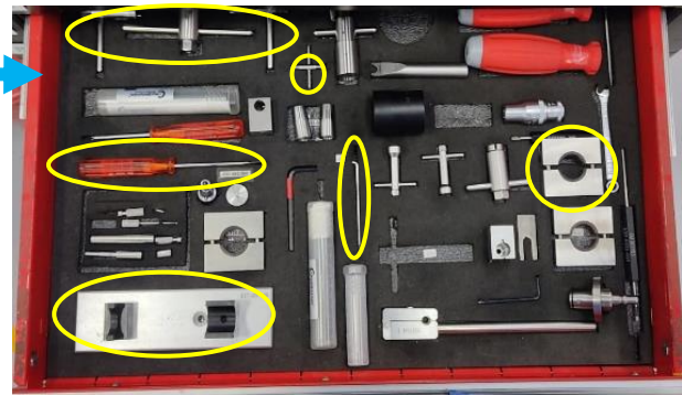
Figura 2. Bandeja A carro 1. Las herramientas encerradas en amarillo son las usadas para desarmar el equipo APD.
