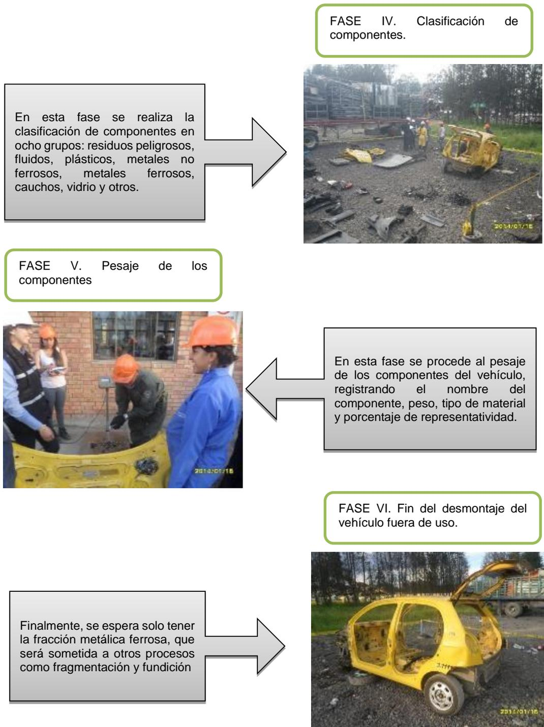
Esquema 3. Proceso de desmontaje y caracterización de un VFU de servicio público Chevrolet Spark modelo 2007.
