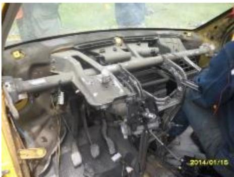
En esta fase se separan las partes interiores y los constituyentes de diferente material unidos entre sí, como el radiador, el múltiple de admisión, la batería, pedales etc.
