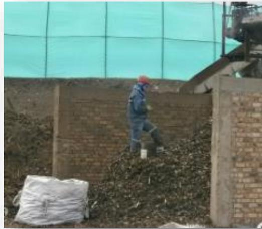
Ilustración 12. Obrero con su equipo de protección personal ejecutando la clasificación manual de metales no ferrosos.
