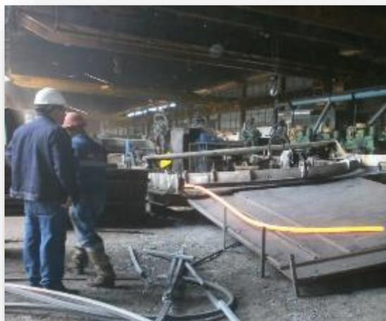
Ilustración 13. Obrero en tren de laminación, sin el equipo de protección personal en su totalidad.
