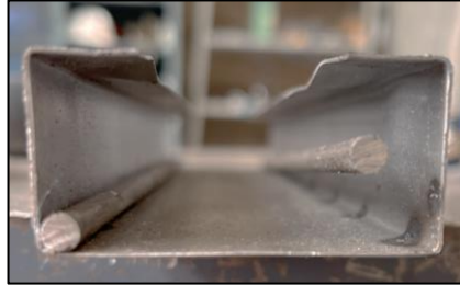
Figura 44. Pandeo local en labios e imperfecciones en el refuerzo.
