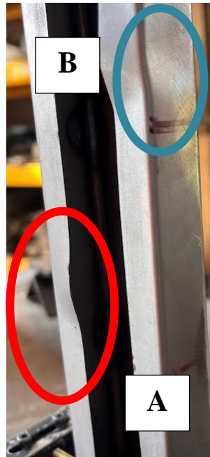
Figura 45. Pandeo local en los labios (A) y aleta (B).
