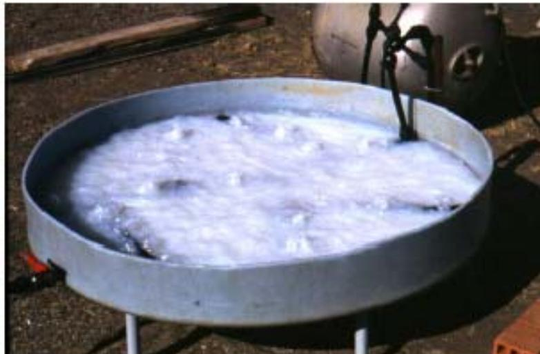
Figura 20. Colector tipo balsa superficial en la PSA, Plataforma Solar de Almería, España (BLANCO, et al, 2001 b, p. 262)
