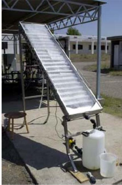
Figura 16. Fotorreactor de película en cascada que utiliza un lecho fijo de dióxido de titanio depositado sobre papel Ahlstrom (HERRMANN, 2005, p. 168)
