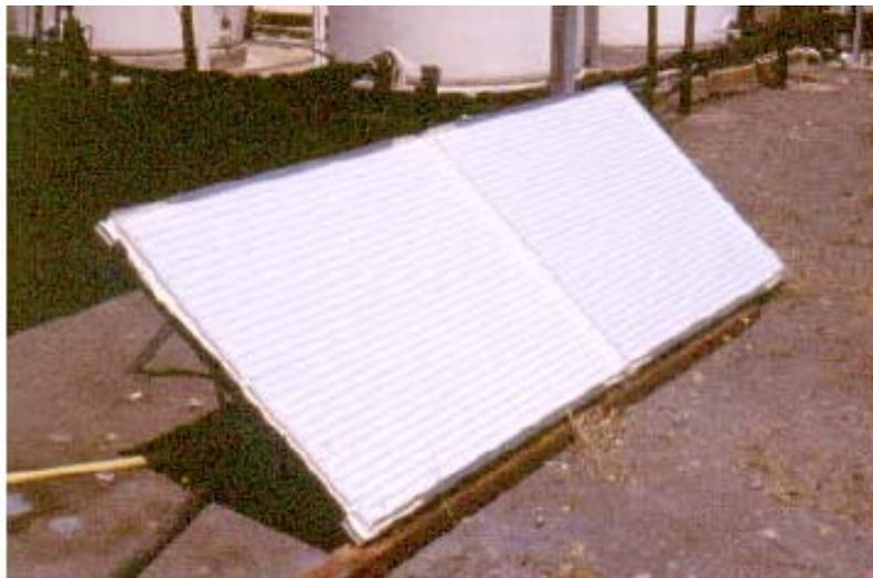
Figura 17. Colector de placa plana hueca construido con materiales plásticos (BLANCO GALVEZ J., et al, 2001 b, p. 261)
