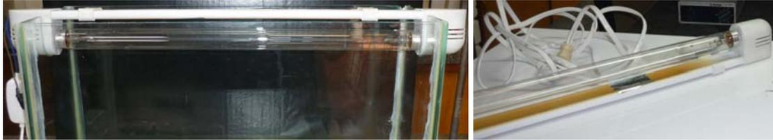
Figura 23. Lámpara germicida para los procesos de tratamiento. Izquierda: dispuesta sobre el tanque en el montaje. Derecha: detalle de la lámpara fuera del montaje.
