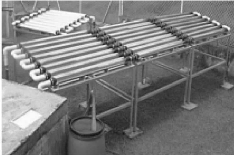
Figura 19. Colector solar utilizado en la experimentación de Garcés y Peñuela (GARCÉS GIRALDO & PEÑUELA MESA, 2004, p. 8)
