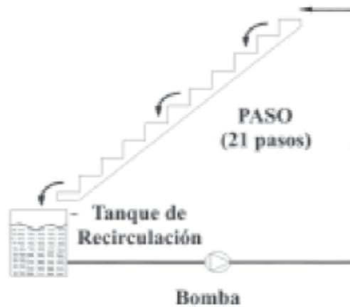
Figura 15. Esquema de fotorreactor de películas en cascada (HERRMANN, 2005, p. 167)
