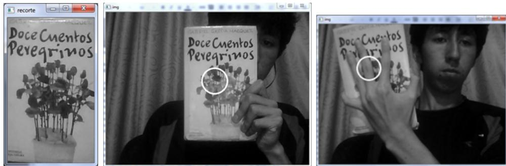
Figura 6.9: Plantilla, Detección normal, Detección con obstrucción
