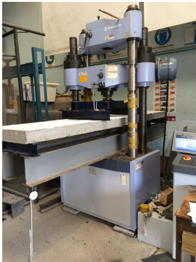
Fotografía No. 5. Montaje de placas con carga estática normal a su plano.
