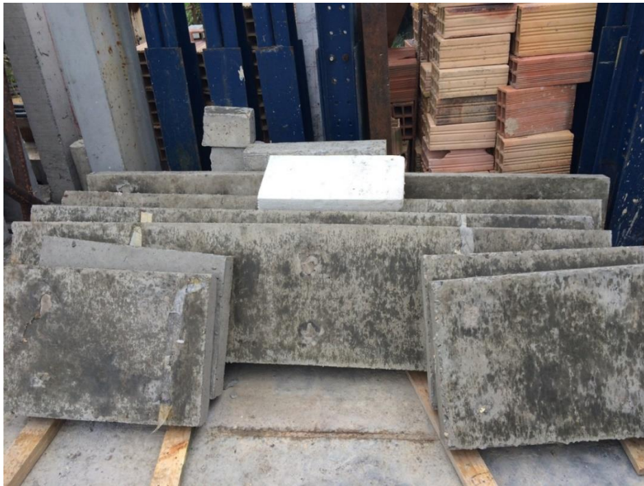
Fotografía No. 3. Placas de concreto reforzado de 0.70m y 2.20m de longitud.
