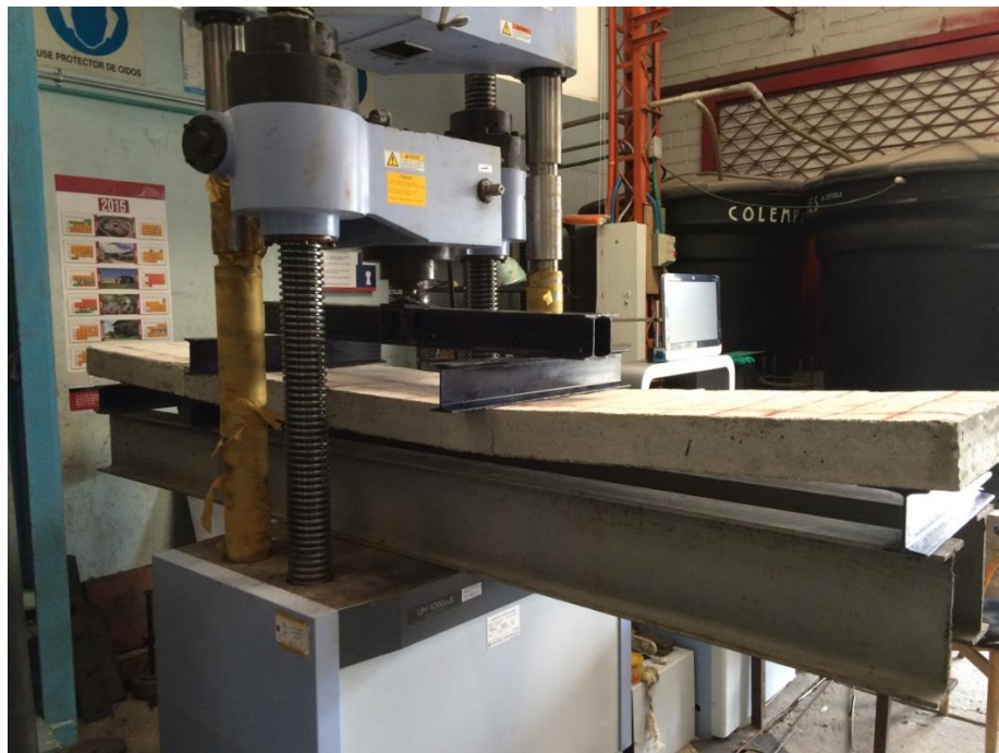
Fotografía No. 8. Falla por flexión de pieza de concreto de 2.20m de longitud.
