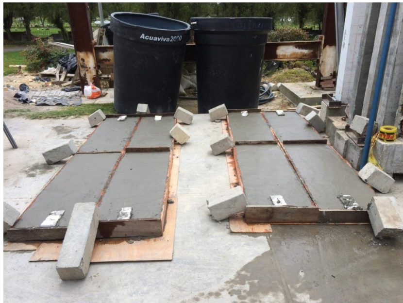
Fotografía No. 6. Placas de concreto reforzado de 0.1m x 1.45m x 0.50m.
