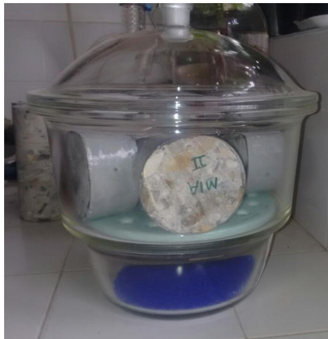
Ilustración 5-23 Preparación de los especímenes para el ensayo de sortividad
