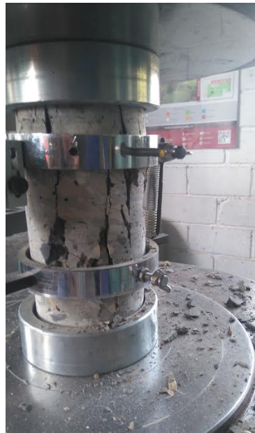
Ilustración 5-8 Ensayo de resistencia a la compresión
