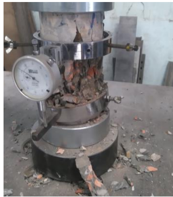
Ilustración 5-15 Muestra de concreto después de la falla
