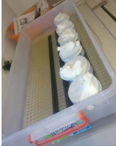
Ilustración 5-24 Montaje ensayo de sortividad
