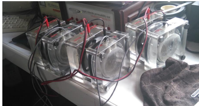
Ilustración 5-28 Montaje de ensayo de permeabilidad de Cloruros
