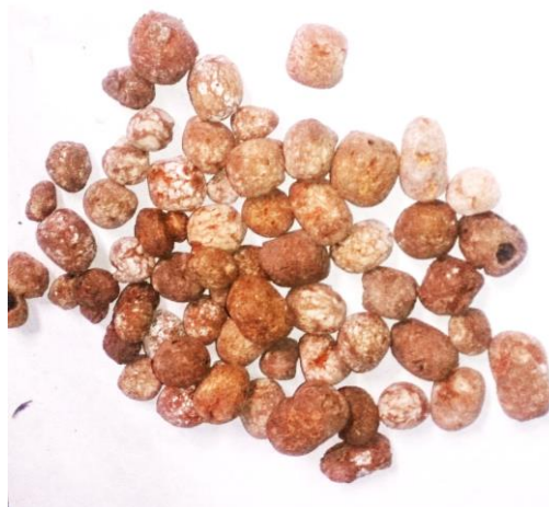
Ilustración 2 agregado de arcilla calcinada
