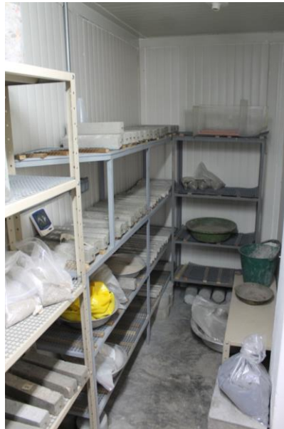
Ilustración 4-10 Cuarto de humedad y temperatura controlada de la Escuela Colombiana de Ingeniería Julio Garavito.
