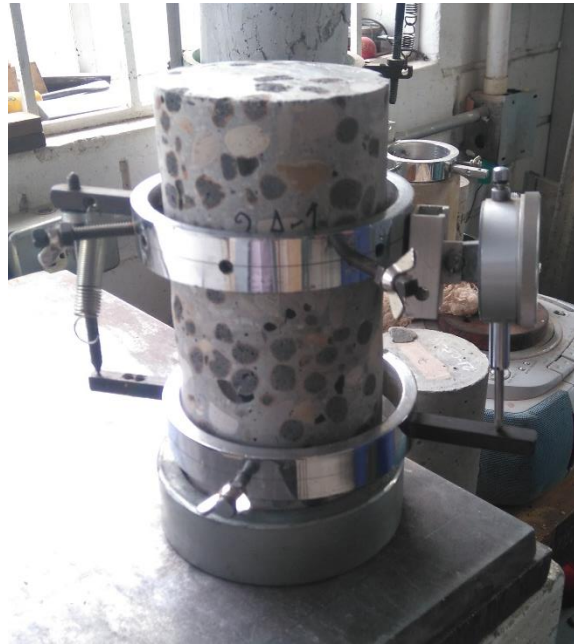
Ilustración 5-13 Montaje módulo de elasticidad
