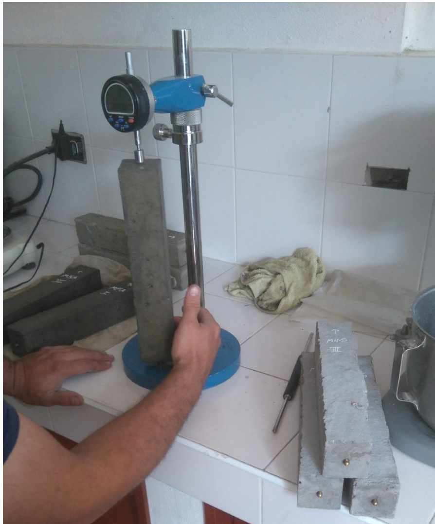
Ilustración 5-31 Montaje ensayo de variación volumétrica
