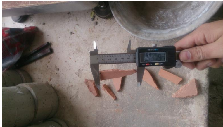
Ilustración 2 media de partícula alargada en agregado de mampostería triturada
