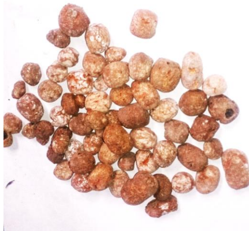
Ilustración 2 agregado de arcilla calcinada
