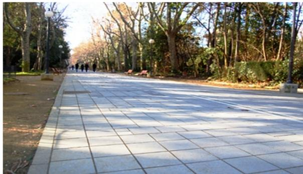
**Figura 20. Pavimento con losetas prefabricadas**
